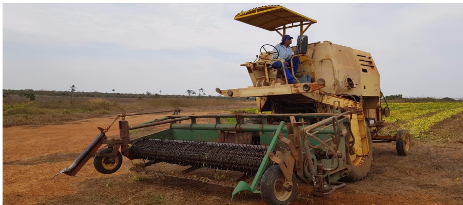
Figura 8. Plataforma Ceiflex acoplada a New Holland 4040.
