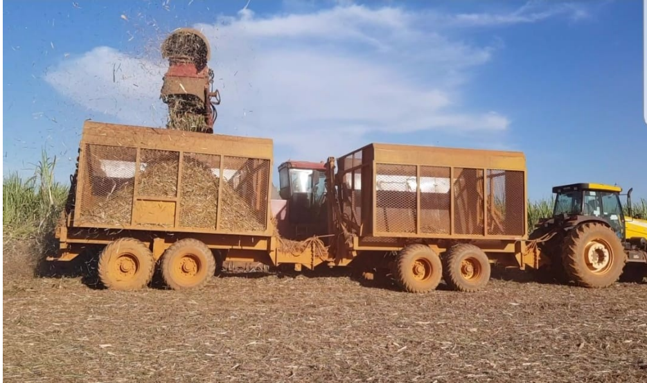
Figura 23. Colhedora despejando os colmos cortados nas gaiolas de transbordo.
