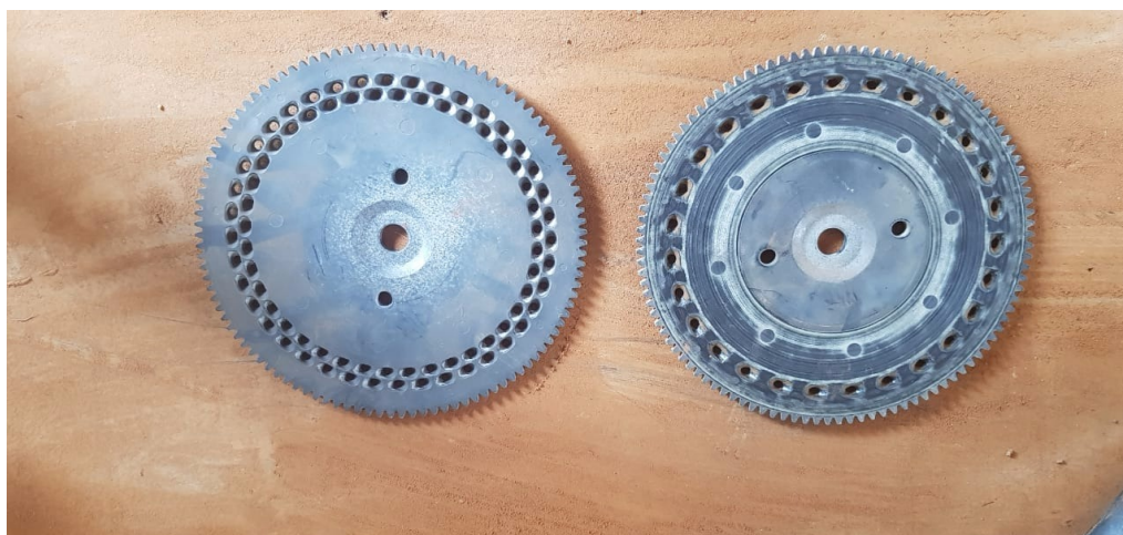
Figura 28. À esquerda, disco de soja, à direita, disco de milho utilizados na plantadeira New Holland PL 6017.
