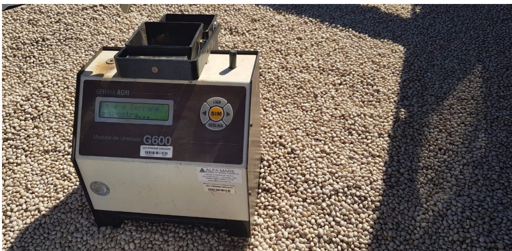
Figura 12. Medidor de umidade de grãos portátil, Gehaka Agri G600.
