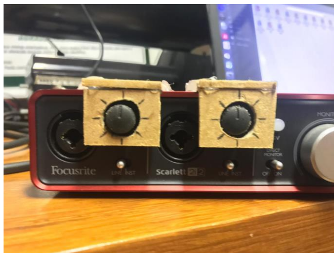
Figura 14 - Configurando um mesmo ganho para os microfones
