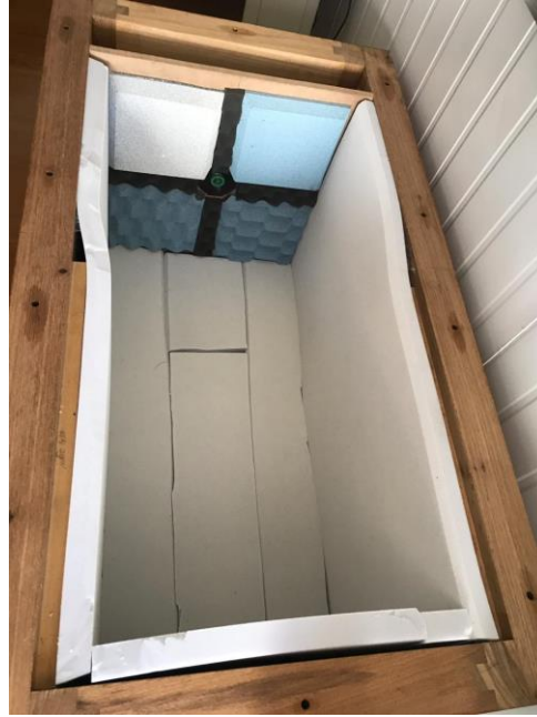
Figura 20 - Colocação das espumas na câmara anecoica
