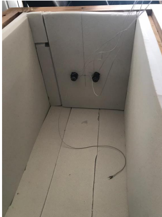
Figura 13 - Posicionamento dos microfones na Câmara de teste
