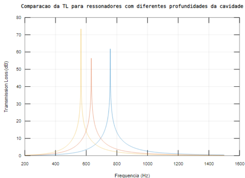
Figura 40 - Comparação da Transmission Loss para diferentes tipos de profundidade de cavidade
