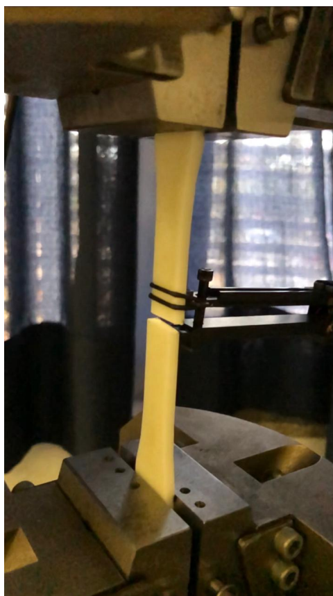
Figura 20 – Corpo de prova após o ensaio de tração. Fonte: Autoral
