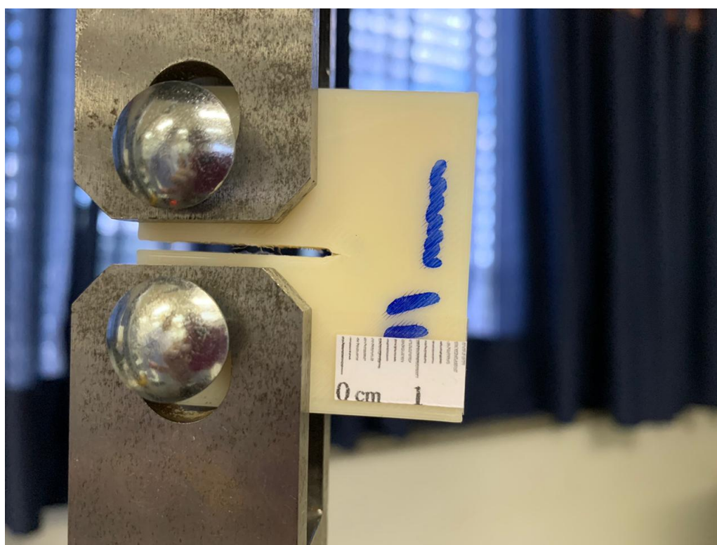
Figura 23 – Corpo de prova no ensaio de tenacidade à fratura. Fonte: Autoral
