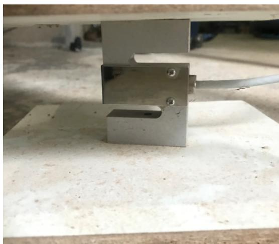
Figura 31 – Célula de carga usada no teste.
