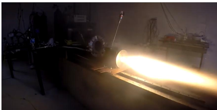
Figura 37 – Teste a quente do motor de foguete híbrido.
