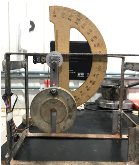
Figura 40 – Servo motor não conseguiu erguer a carga de 5 kg.
