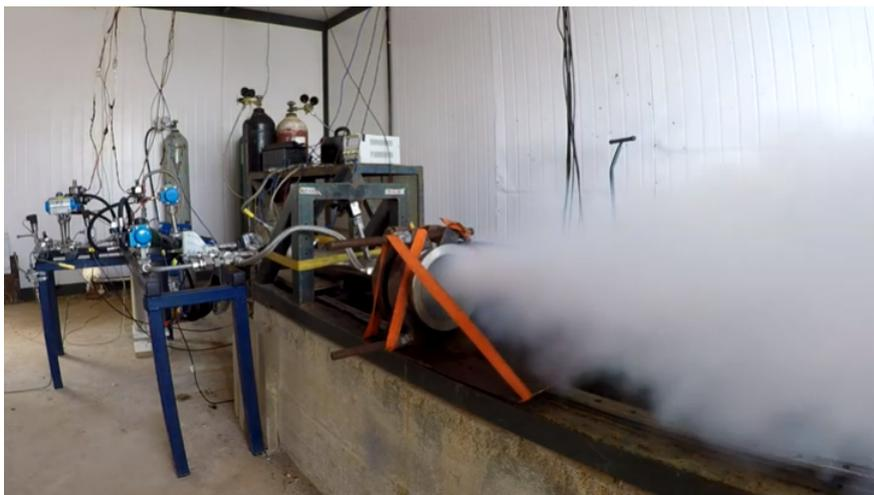
Figura 36 – Teste a frio com óxido nitroso.
