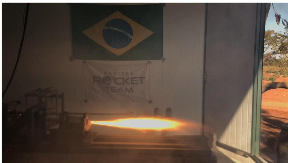
Figura 5 – Teste estático do motor Firestorm, realizado na bancada de testes do CPL.
