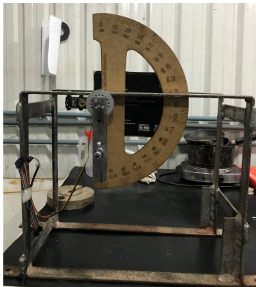
Figura 34 – Bancada de testes do servo motor.
