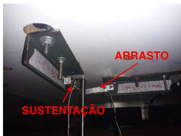
Figura 39 – Posicionamento das células de carga de sustentação e arrasto.
