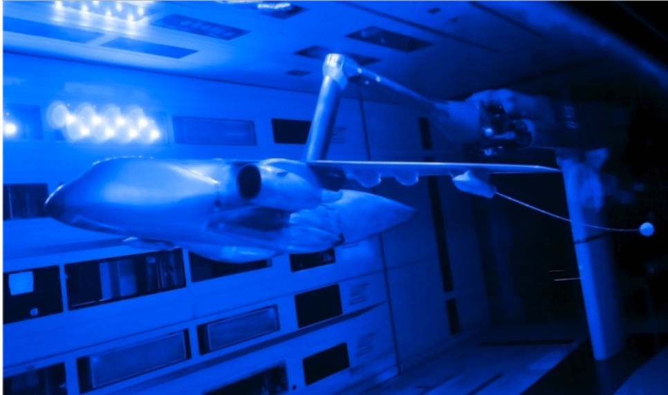
Figura 10 – Ensaio do modelo KC390 no DNW German-Dutch Wind Tunnels (NLR, 2013).
