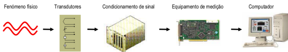
Figura 12 – Diagrama de um sistema de aquisição (Serrano C. J. O. P. J. Alcobia (2004)).
