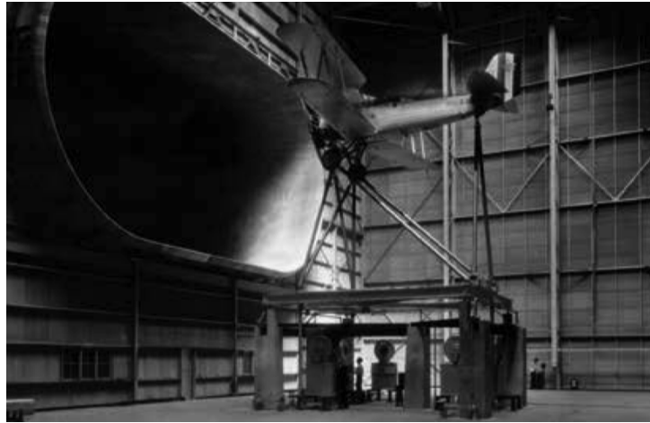
Figura 3 – Túnel de vento com seção de teste aberta (CHAMBERS, 2014).
