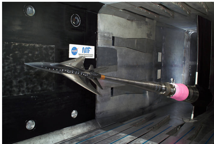
Figura 4 – Túnel de vento com seção de teste fechada (GIPSON, 2015).
