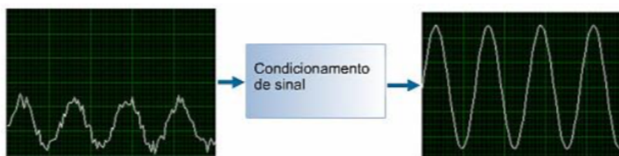
Figura 13 – Exemplo de condicionamento: filtragem e amplificação(Serrano C. J. O. P. J. Alcobia (2004)).
