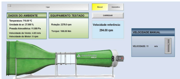
Figura 40 – Software de controle do túnel.
