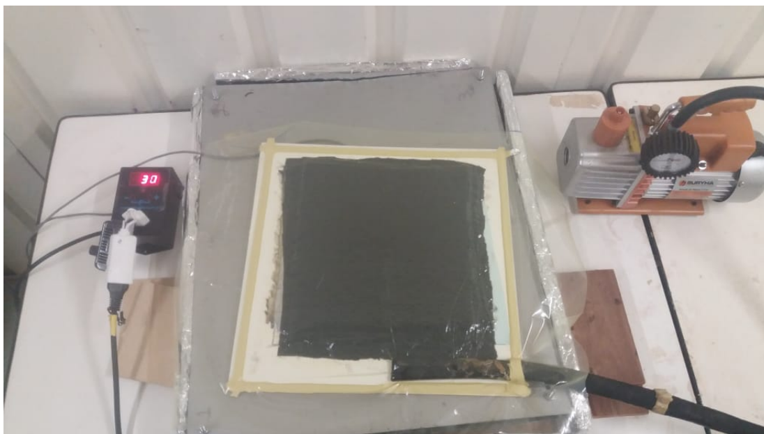
Figura 23 – Laminação a 30 °C da fibra de vidro - fonte: próprio autor.
