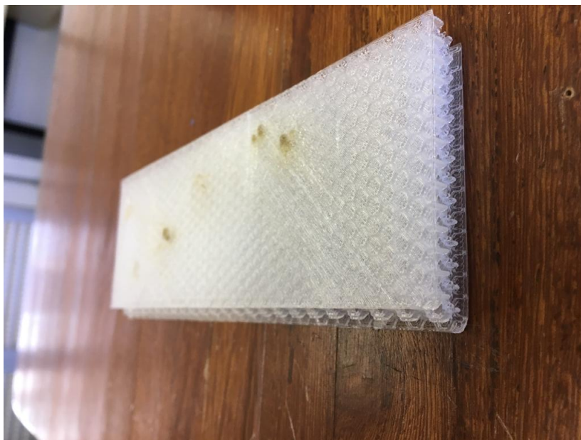
Figura 45 – Erro de confecção causado por vazamento - fonte: próprio autor.
