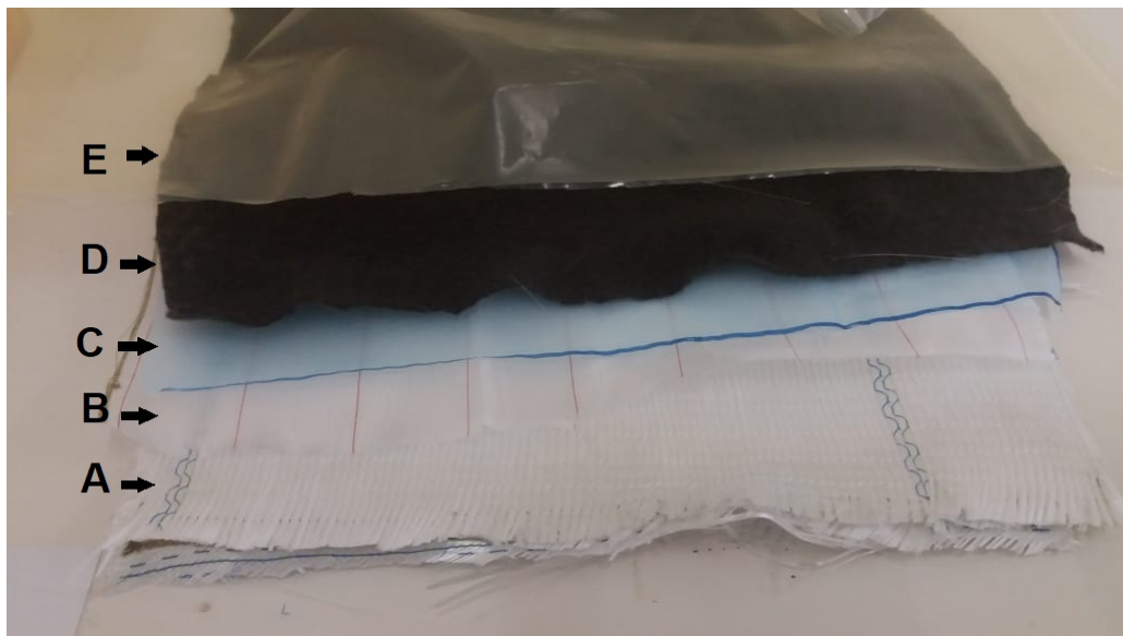
Figura 22 – Ordem de camadas de material para laminação - fonte: próprio autor.
