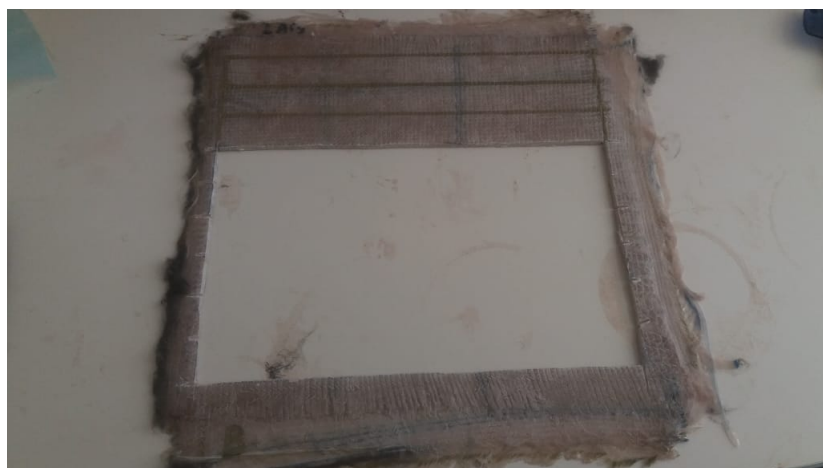
Figura 25 – Marcação e corte dos corpos de prova no laminado de fibra de vidro - fonte: próprio autor.
