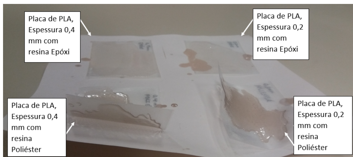
Figura 33 – Teste de resina sobre placas de PLA de 0,2 e 0,4 mm - fonte: próprio autor.
