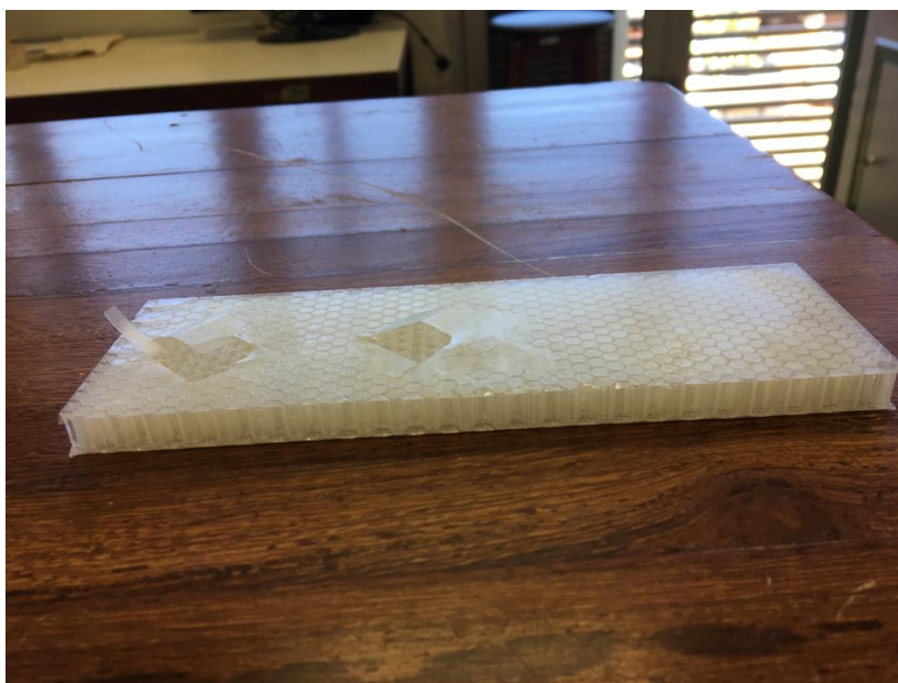
Figura 46 – Peça inacabada por falta de filamento - fonte: próprio autor.
