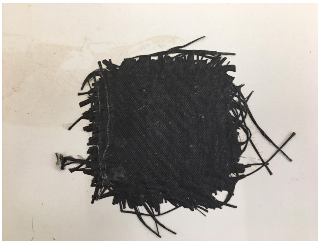
Figura 29 – Laminado de fibra de carbono ao final - fonte: próprio autor.
