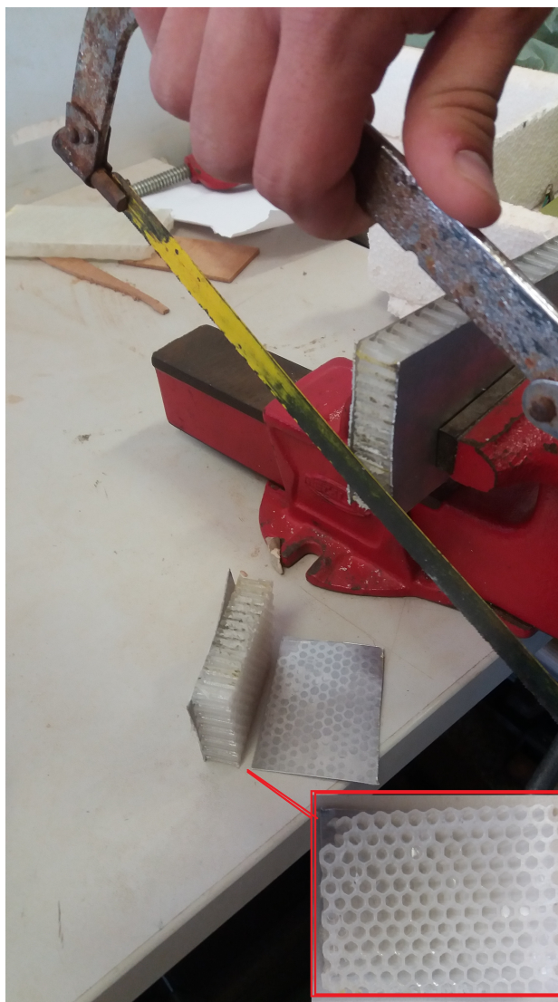
Figura 34 – Corte do painel sanduíche, com ampliamento de seu núcleo- fonte: próprio autor.
