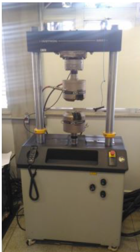
Figura 41 – Máquina de Ensaio Universal Instron 8801 - fonte:( SILVA, 2017b )
