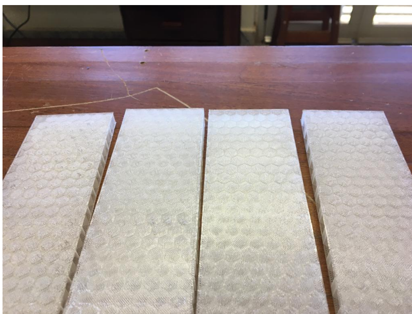
Figura 20 – Defeitos ocasionados pelas velocidades da antepenúltima camada. Velocidades de impressão: 80 mm/s, 55 mm/s, 50 mm/s e 40 mm/s (da esquerda para a direita) - fonte: próprio autor.
