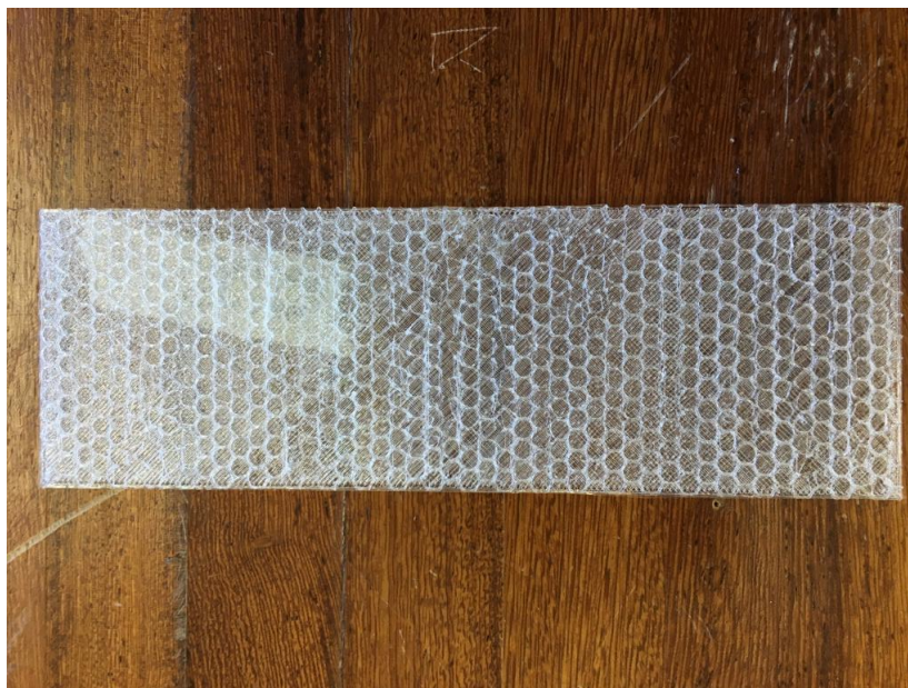
Figura 44 – Consequência do entupimento do bico extrusor - fonte: próprio autor.
