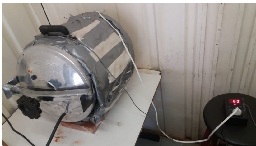
Figura 27 – Pós-cura fibra de carbono - fonte: próprio autor.
