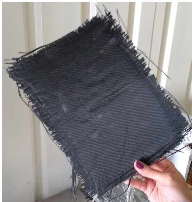
Figura 31 – Placa laminada de fibra de carbono e poliéster - fonte: próprio autor.
