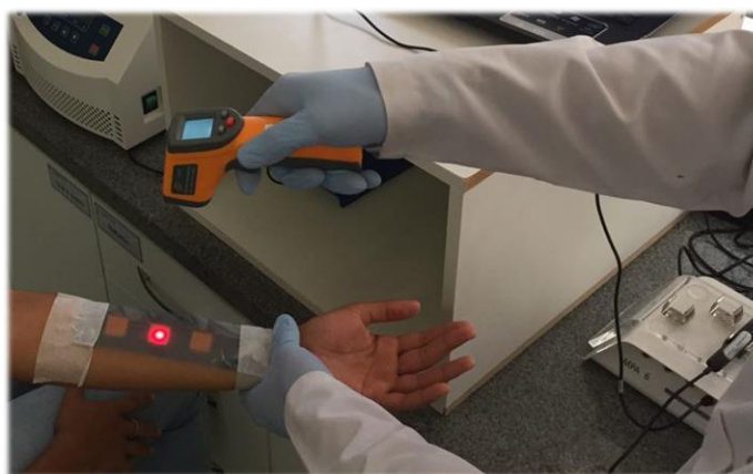
Figura 8: Aferição da temperatura realizada por infravermelho.
