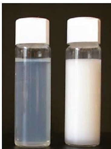
Figura 4: Aspeto de uma nanoemulsão (à esquerda) e de uma emulsão convencional (à direita) com gotículas de, aproximadamente, 35 nm e de 1 \mu\text{m} de diâmetro, respectivamente.
