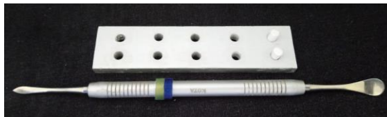
Figura 3 – Matriz metálica com corpos de prova e espátula 7 utilizada para inserção dos cimentos nos orifícios
