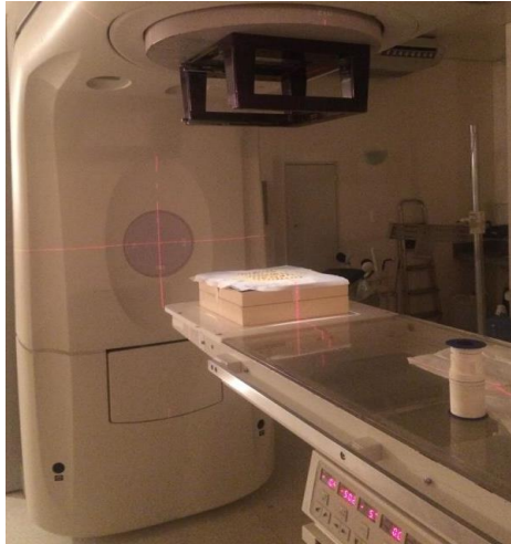
Figura 4 – Acelerador linear, modelo Primus (Siemens, Alemanha), utilizado para aplicação da radiação ionizante sobre as amostras dos respectivos grupos
