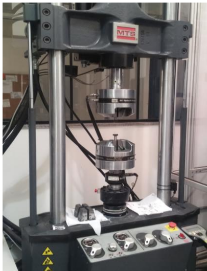
Figura 5 – Máquina MTS Landmark de ensaios universais (MTS Systems Corporation, EUA), utilizada para os testes de compressão
