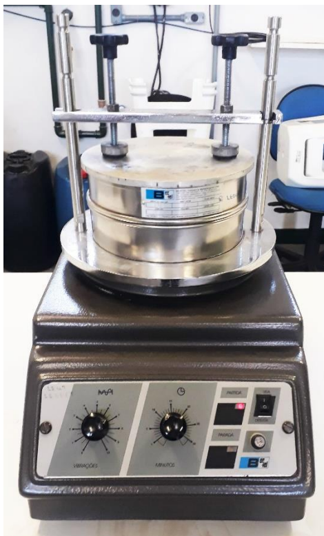
Figura 7 - Foto ilustrativa do sistema de classificação das partículas pulverizadas de scheelita.
