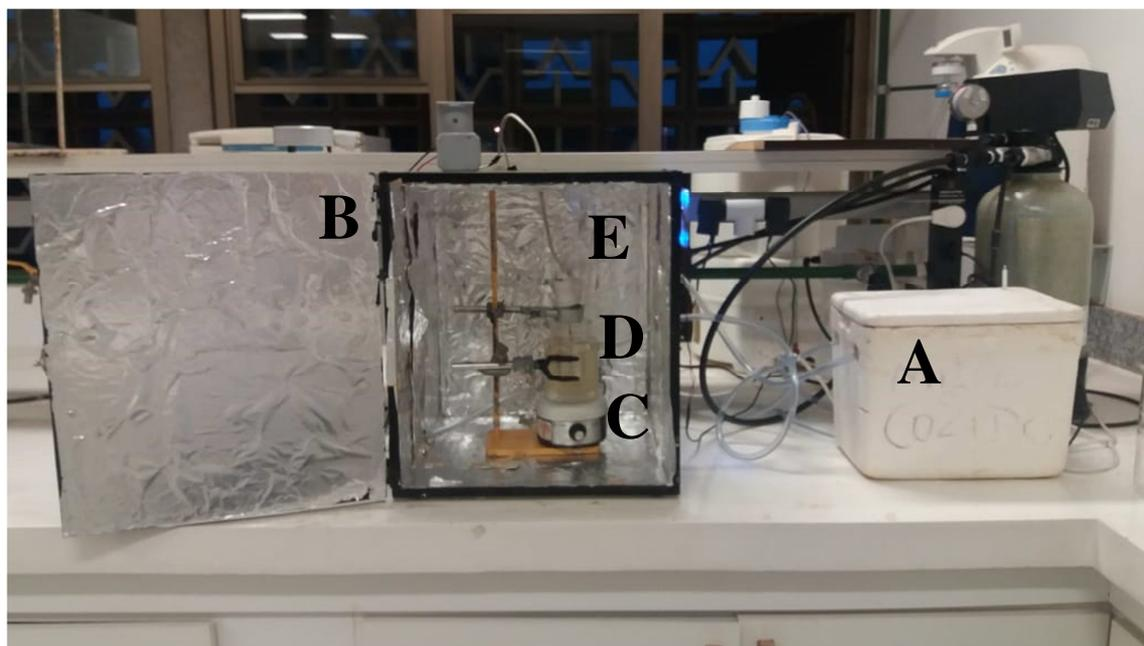
**Figura 5** - Reator fotoquímico: A-sistema de resfriamento, B- Parte interna laminada, C- agitador magnético, D- reator, E- Luz UV.
