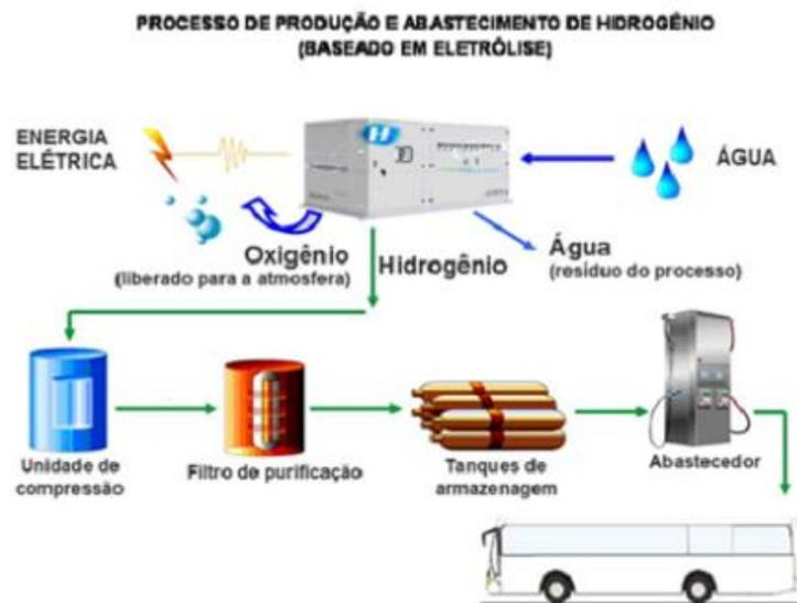
**Figura 2.** Processo de produção e abastecimento de hidrogênio para ônibus movido a células a combustível de hidrogênio. (Finep).
