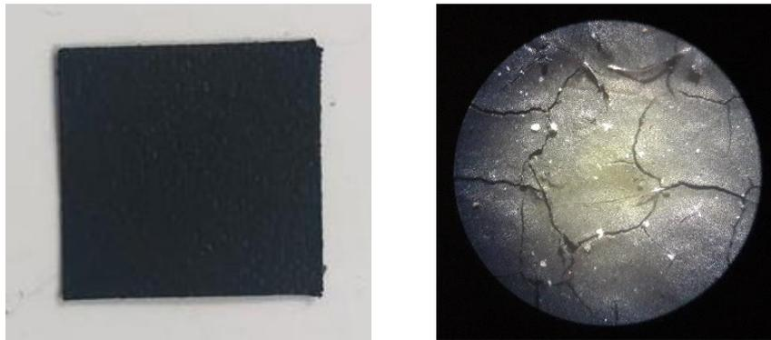
**Figura 12.** Imagens da camada difusora (área = 4 cm<sup>2</sup>) e da visualização no microscópio óptico, respectivamente.
