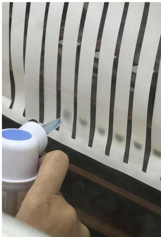
**Figura 10** – Bico adaptado para nebulização da solução reveladora.
