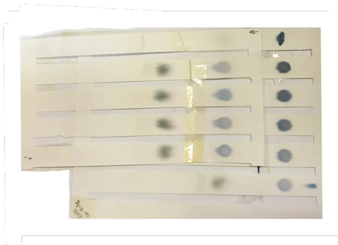
**Figura 11** – Exemplo do posicionamento do papel para análise de níquel.
