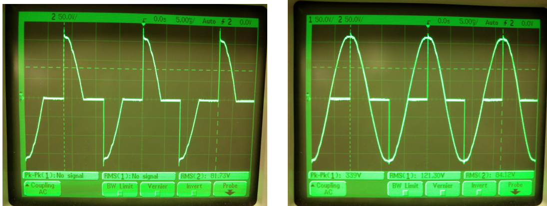
Figura 48 – Tensão no resistor com ângulo de disparo ( \alpha ) de 90^\circ .
