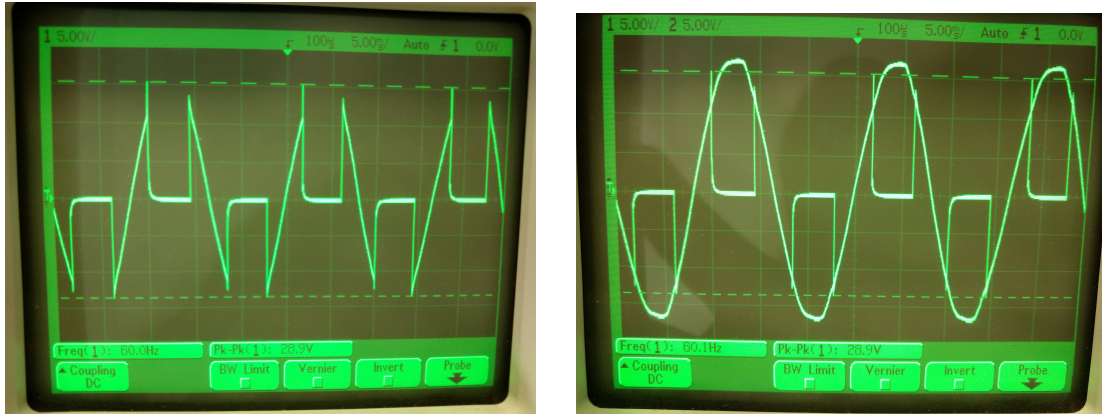
Figura 54 – Tensão no indutor com ângulo de disparo ( \alpha ) de 150^\circ .
