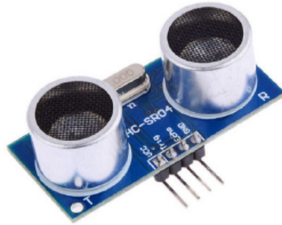
Figura 10 – Sensor ultrasônico HC-SR04. Fonte: (Felipe Flop, 2016)
