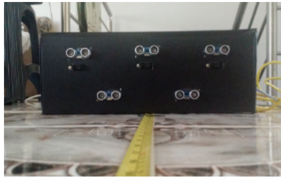
Figura 22 – Vista frontal da estrutura para calibração dos sensores frontais
