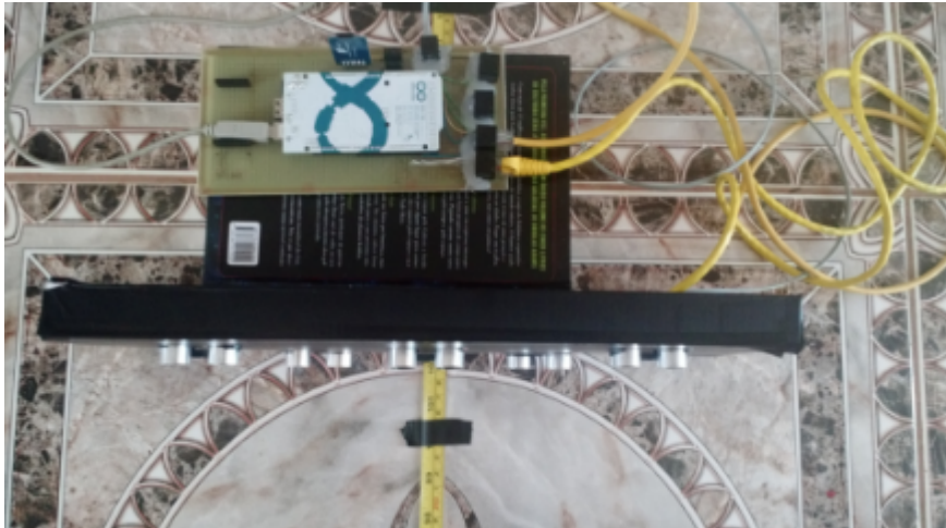
Figura 21 – Vista superior da estrutura para calibração dos sensores frontais
