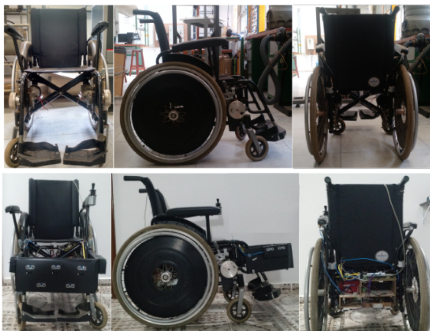
Figura 35 – Visão frontal, lateral e traseira da cadeira antes e depois da instalação dos sensores.
