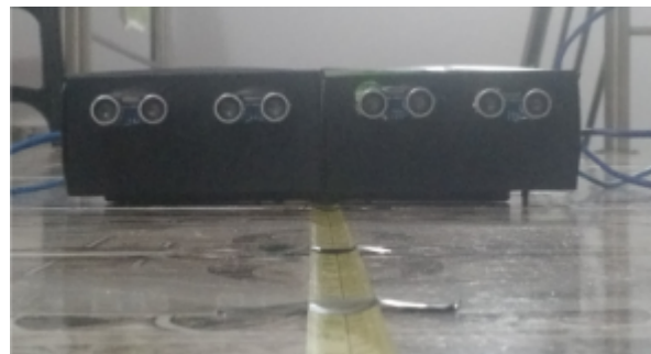
Figura 23 – Vista frontal da estrutura para calibração dos sensores laterais
