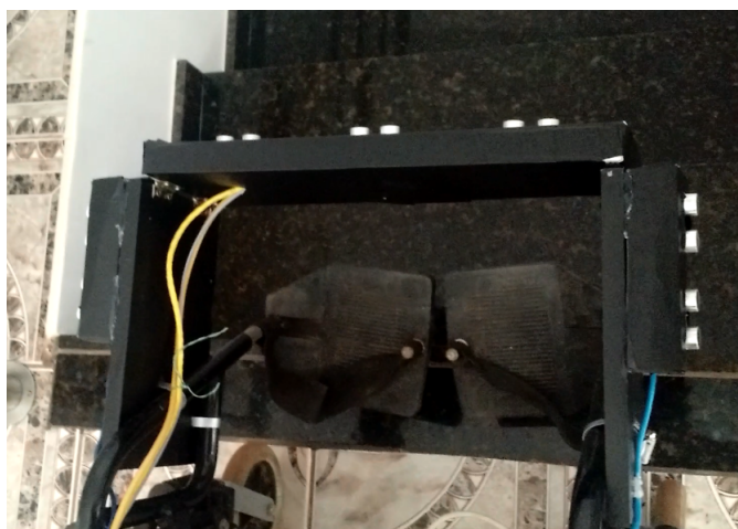
Figura 47 – Posição na qual os sensores infravermelhos detectam o degrau à frente da cadeira
