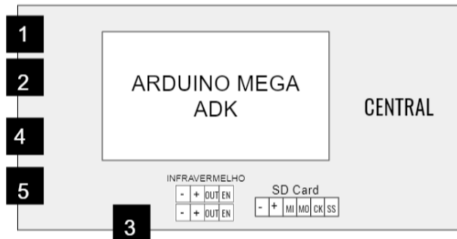
Figura 16 – Descrição dos pinos de cada conector dos sensores na placa central
