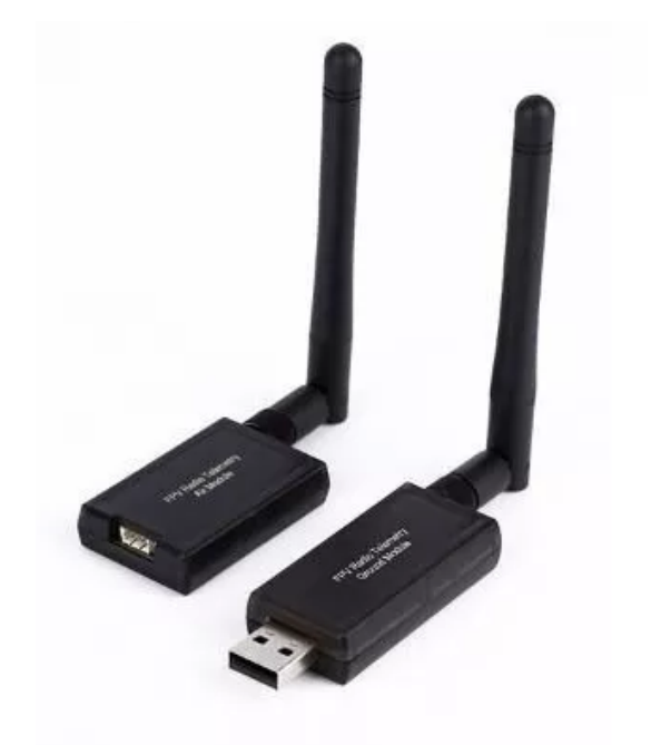
Figura 14: Kit de telemetria da 3DR de 433MHz, a esquerda placa serial e a direita placa USB.
