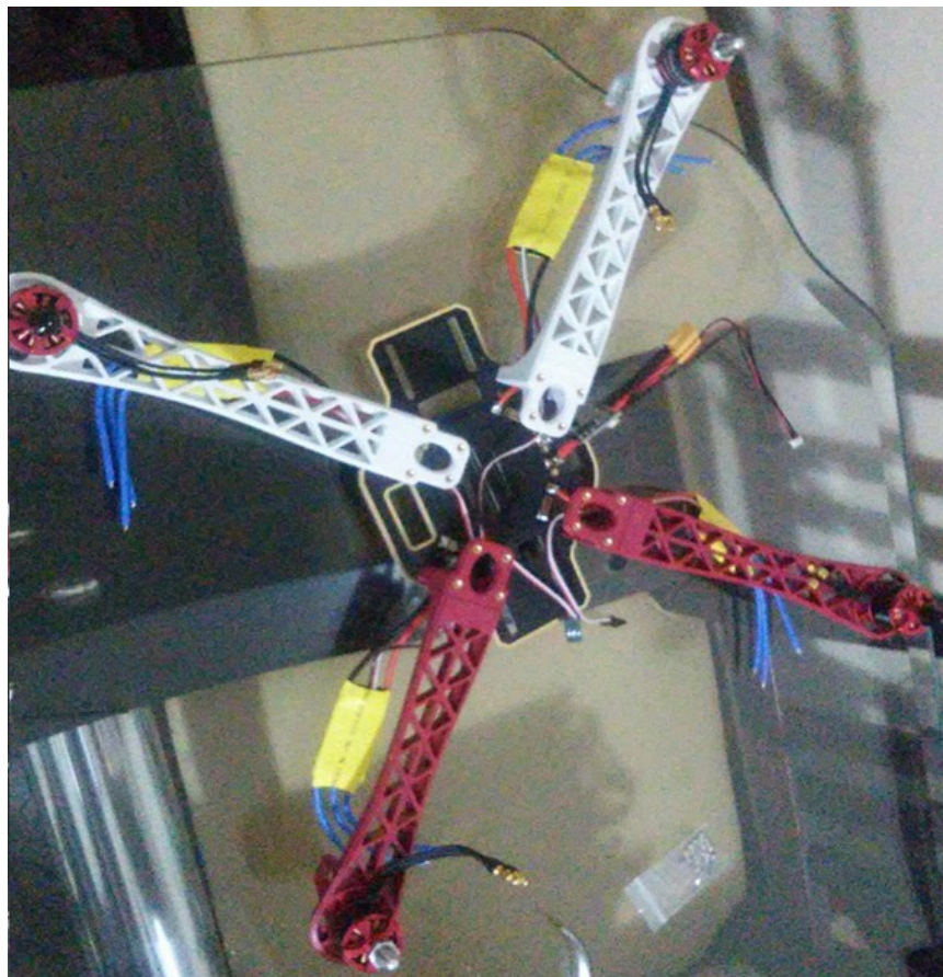
Figura 24: Base do frame montado com motores.
