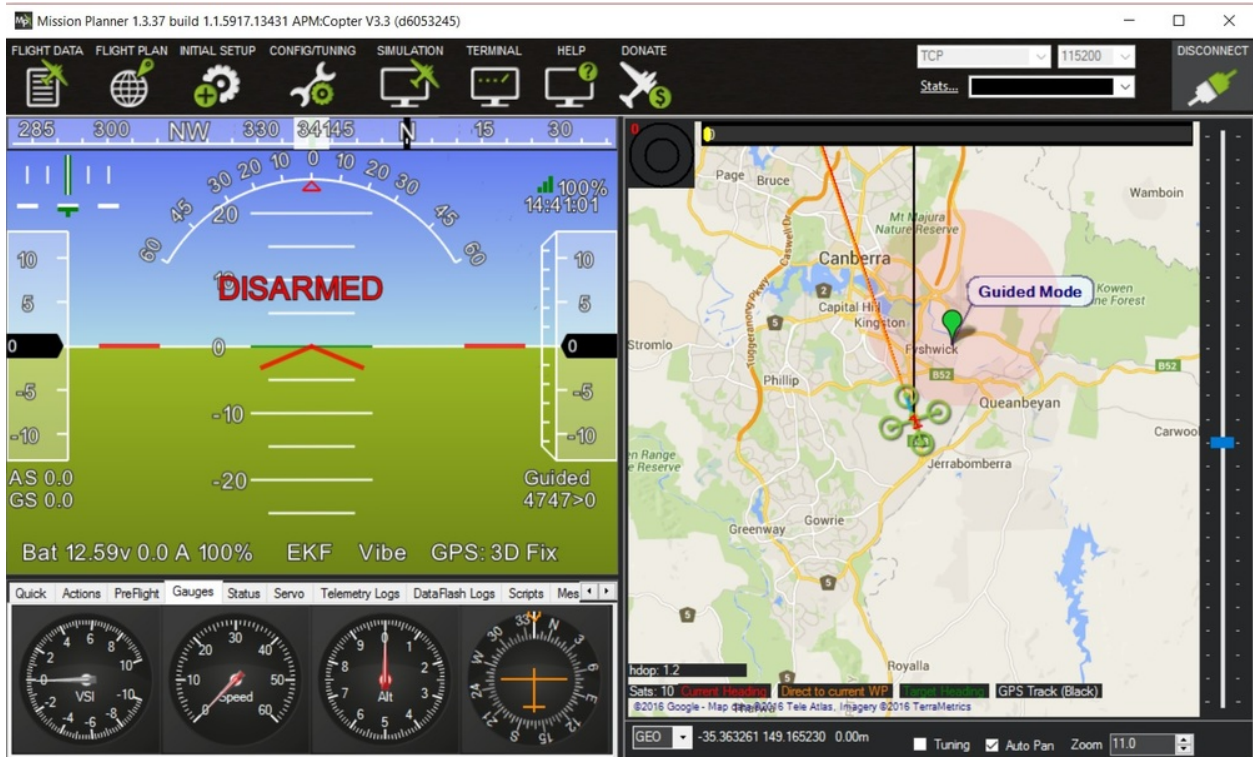
Figura 9: Interface do Mission Planner, permitindo visualizar informações da aeronave e sua localização via GPS.
