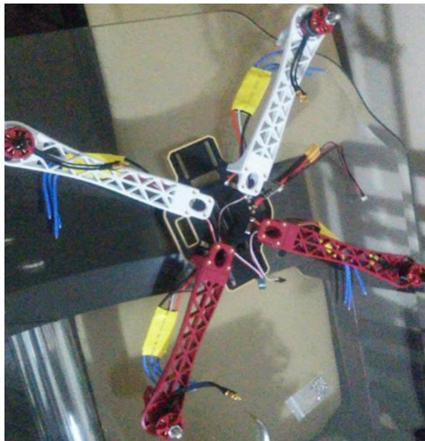
Figura 42 – Braços e motores parafusados à estrutura
