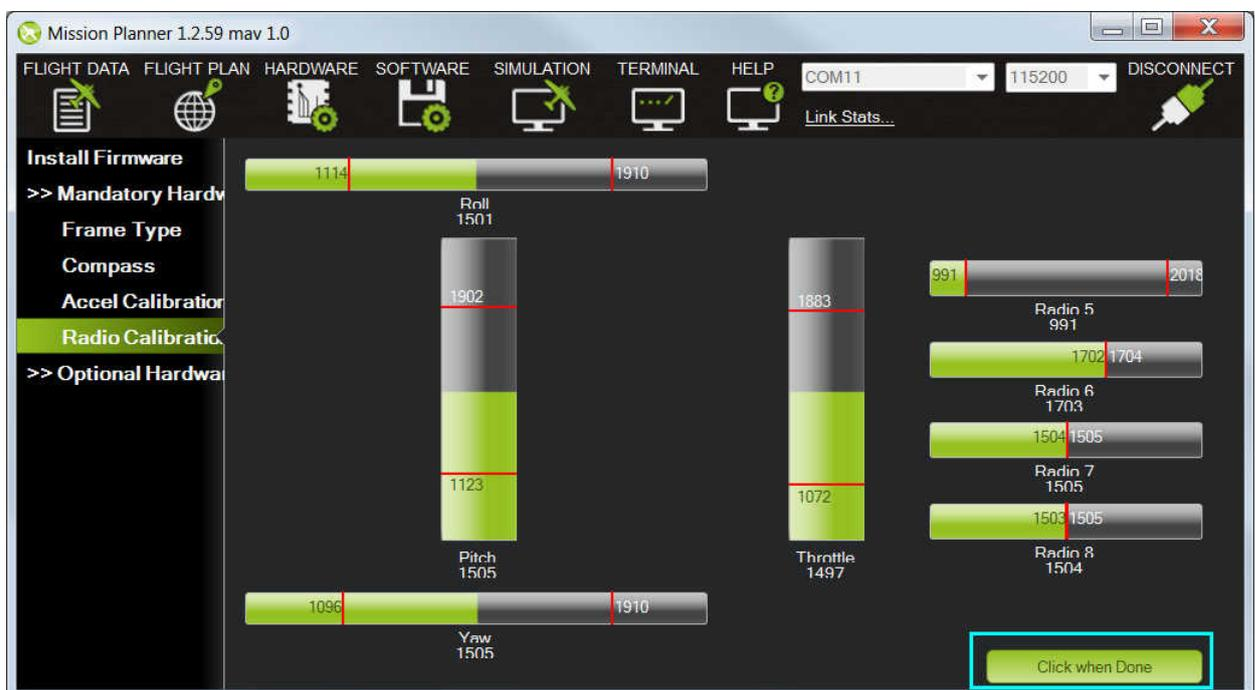
Figura 47 – Calibração do Rádio com limites dos sticks e chaves em vermelho.
