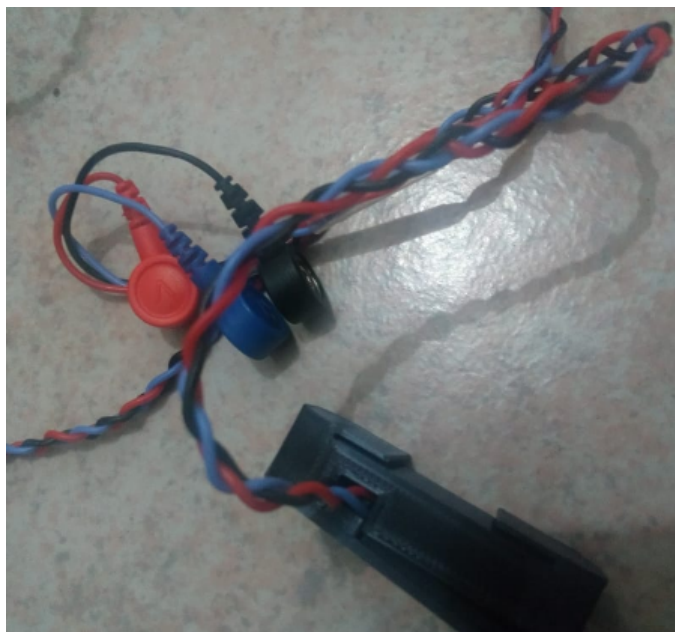
Figura 29 – Myoware com case e cabos
