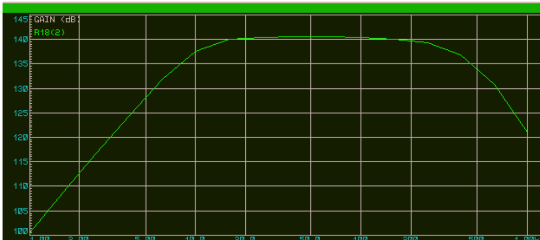
Figura 27 – Resposta em frequência do circuito completo
