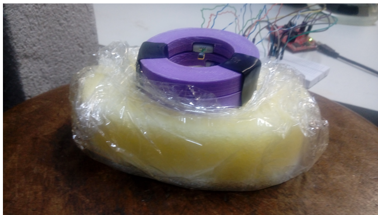
Figura 9 – Equipamento prototipado posicionado sobre a esponja realizando medições.
