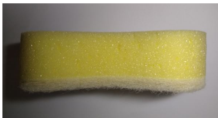
Figura 11 – Esponja utilizada no experimento. Parte superior é menos áspera e a parte inferior é mais áspera.
