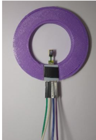
Figura 25 – Adaptador acoplado à peça que forma a câmara aberta.
