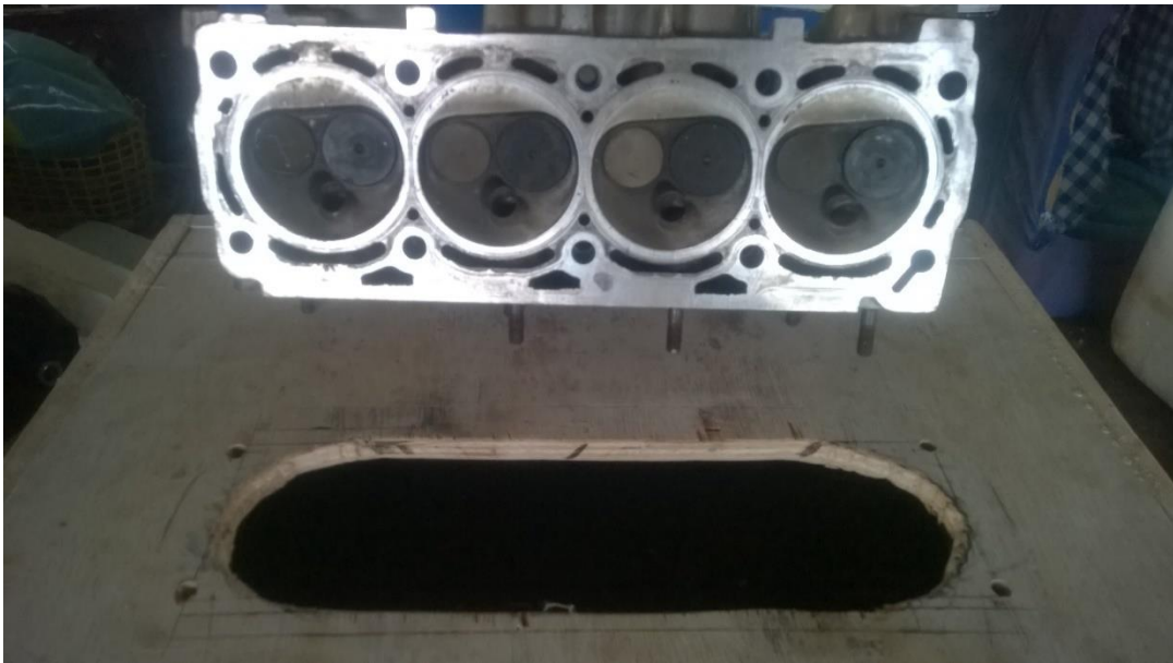
Figura 15 – Abertura de conexão do plenum de madeira ao cabeçote
