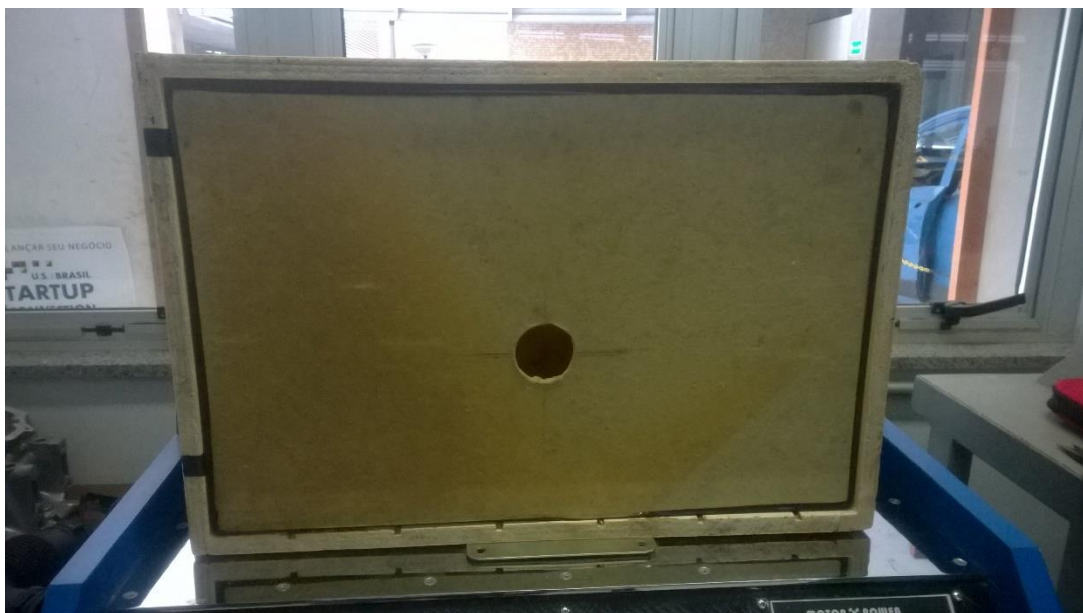
Figura 16 – Base inferior do Plenum de madeira com a abertura de conexão com a bancada.
