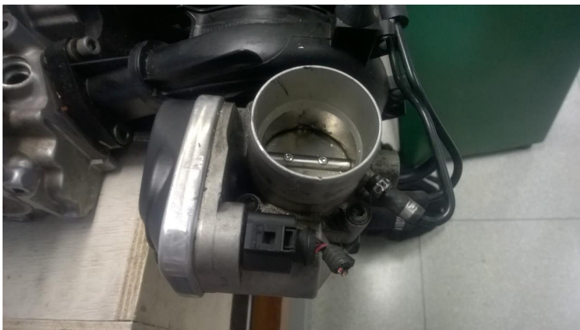
Figura 21– TBI do coletor (borboleta de admissão do ar)
