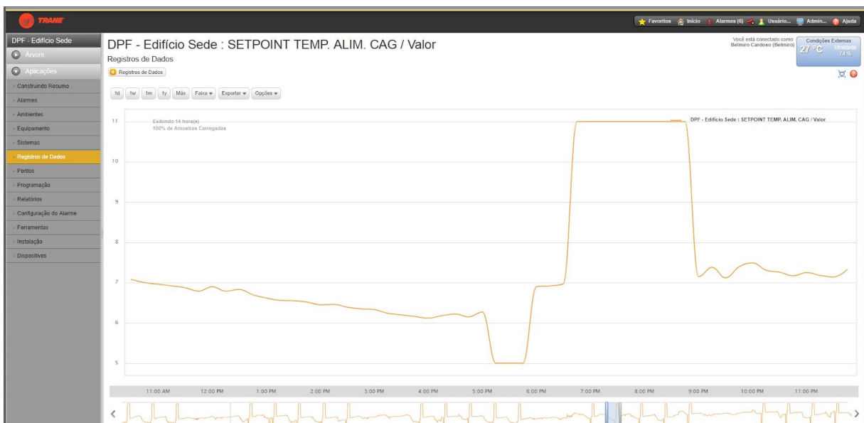
Figura 10: Curva da Temperatura da Água Gelada na Saída do Chiller (Sistema de Automação Tracer)
