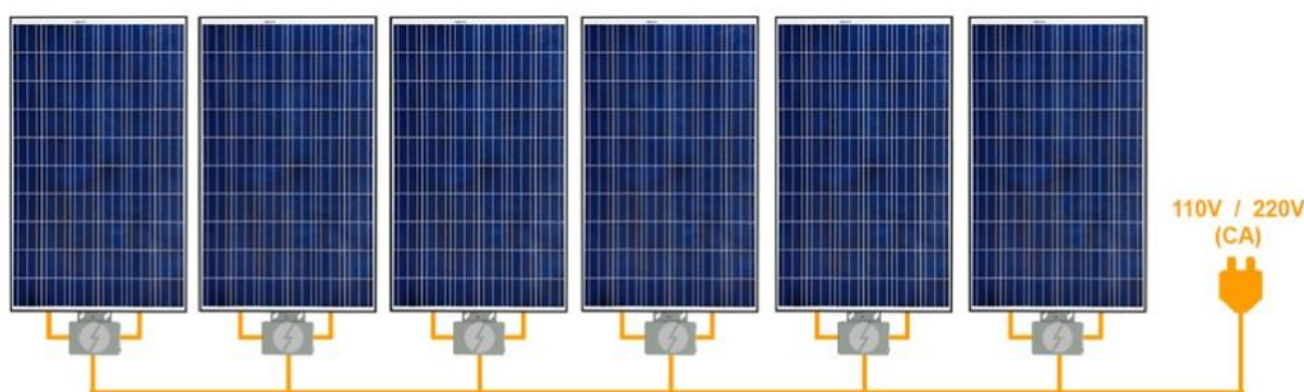
Figura 23 - Painéis Solares conectado a um microinversor [37]
