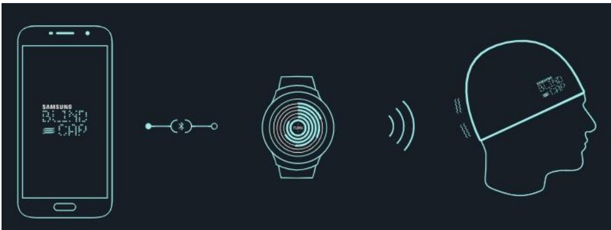
Figura 9. Demonstração do funcionamento da Blind Cap . Em primeiro plano podemos observar conexão do celular com o acessório via Bluetooth , estes quando selecionados pelo técnico, enviam o estímulo ao atleta, levando ao alerta vibratório localizado na touca. Fonte: http://www.blindcap.com/es/ .
