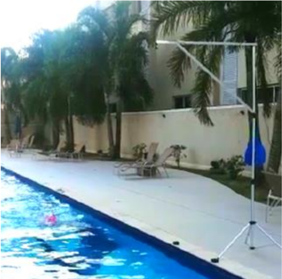
Figura 7. Suporte para posicionamento adequado da câmera no volume de espaço de interesse para detecção da proximidade. O ambiente e o nadador são simulações do real, dado que não se trata de piscina de competição, nem de nadador com deficiência visual.
