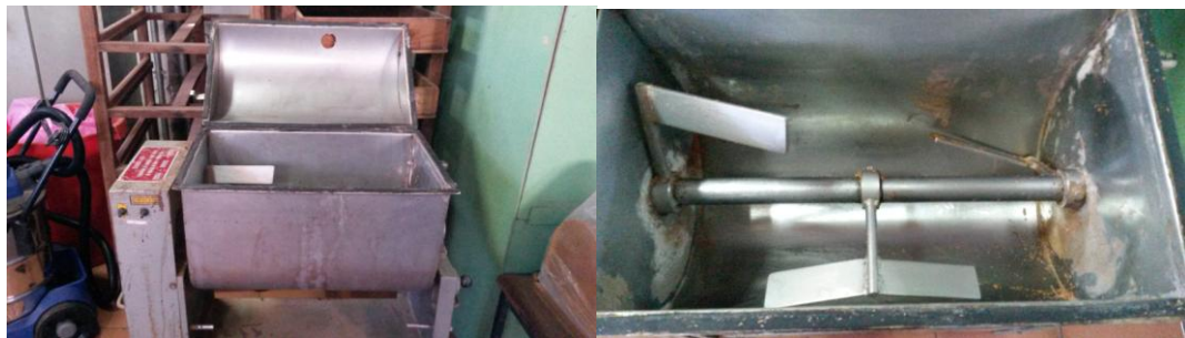
Figura 8: Misturador de partículas e adesivo visto de frente e de cima. Foto da autora.
