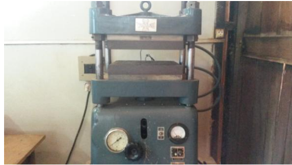
Figura 11: Prensa utilizada para prensagem a quente dos painéis. Foto da autora
