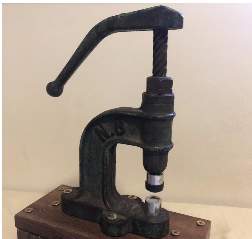
Figura 31 – Prensa manual de botões de pressão, ou Balancin.
