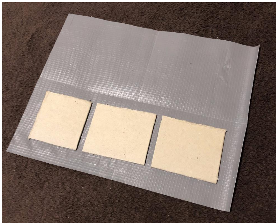
Figura 20 – Colagem do papel paraná por entre as camadas de lona.
