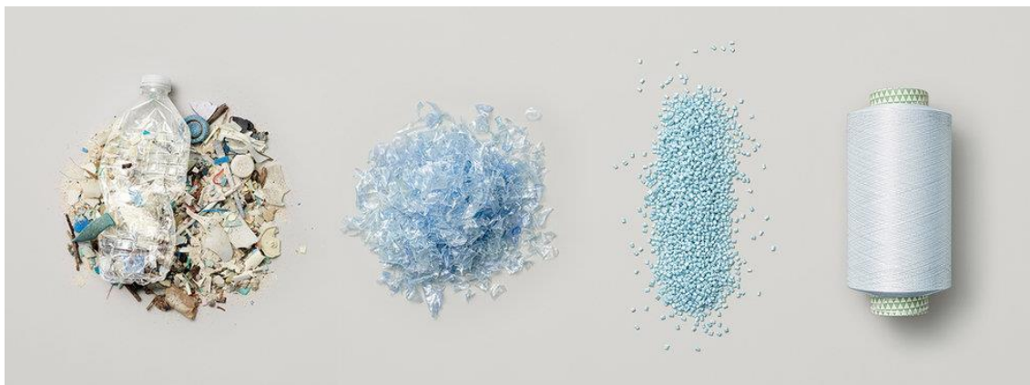
Figura 69: Processo simplificado da transformação do plástico em fios.
