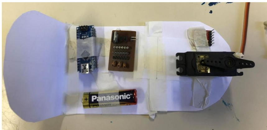
Figura 2: Exemplo de estudo de posicionamento dos componentes da eletrônica embarcada. Em um modelo feito a partir de material alternativo.
