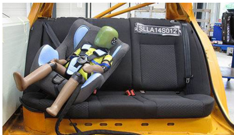
Figura 52 - Teste de segurança em impacto lateral de cadeirinha FONTE: Quatro Rodas (2017)
