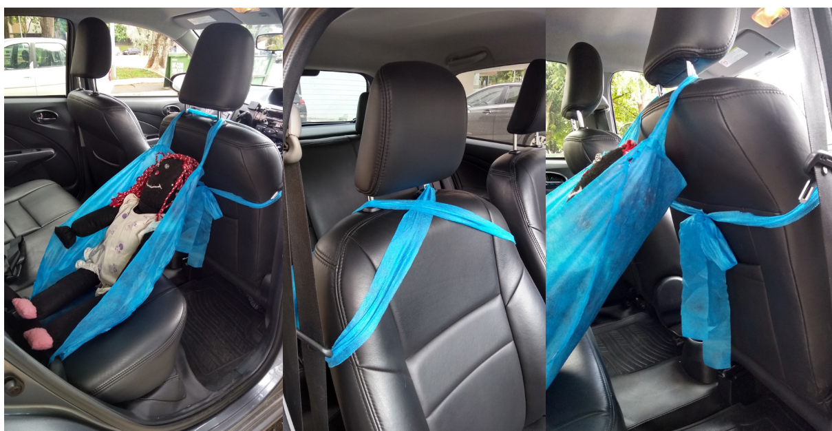
Figura 86 - Primeiro modelo de dispositivo de retenção infantil feito em tnt FONTE: A autora (2018)
