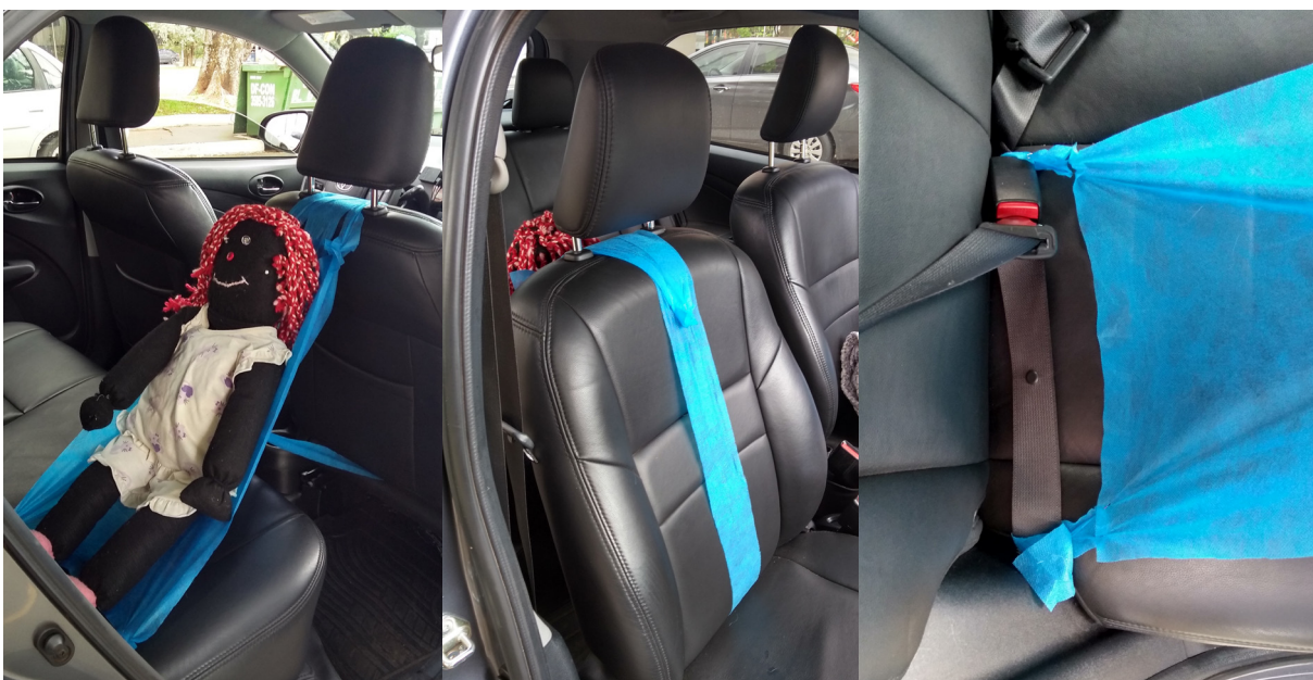
Figura 88 - Segundo modelo de dispositivo de retenção infantil feito em tnt FONTE: A autora (2018)
