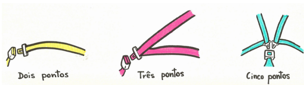
Figura 20 - Tipos de cinto de segurança: Dois pontos, Três pontos e Cinco pontos FONTE: A autora (2018)
