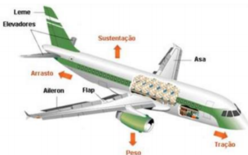
Figura 2 – Componentes estruturais do avião (GARCIA, 2015)
