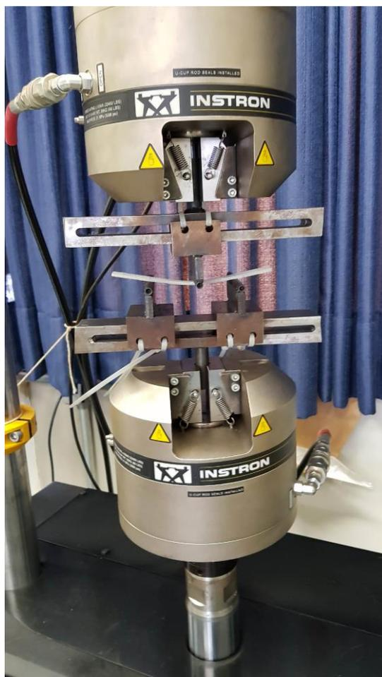
Figura 42: Ensaio de Flexão realizada no laboratório (Fonte: Próprio autor, 2018).
