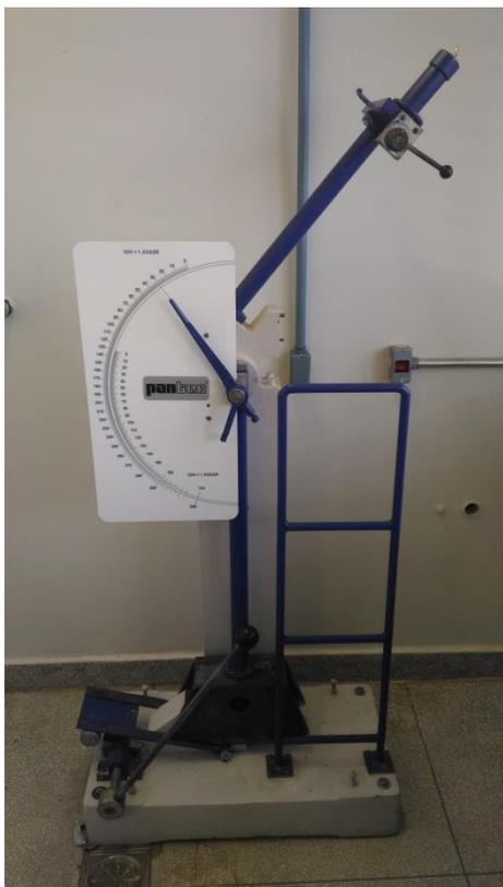
Figura 43: Equipamento de Impacto de Charpy (Fonte: Próprio autor, 2017).
