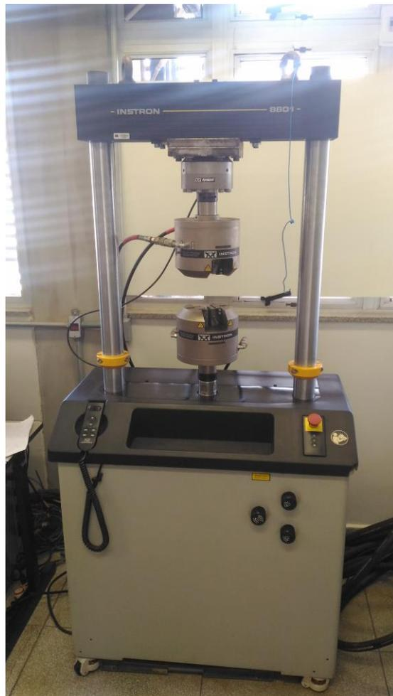
Figura 37: Equipamento de ensaio de tração (Fonte: Próprio autor, 2017).
