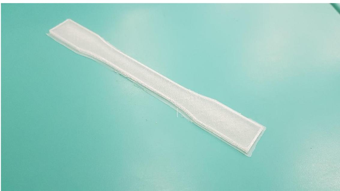
Figura 40: Peça de tração ainda com o material na base para maior adesão a mesa de impressão (Fonte: Próprio autor, 2018).
