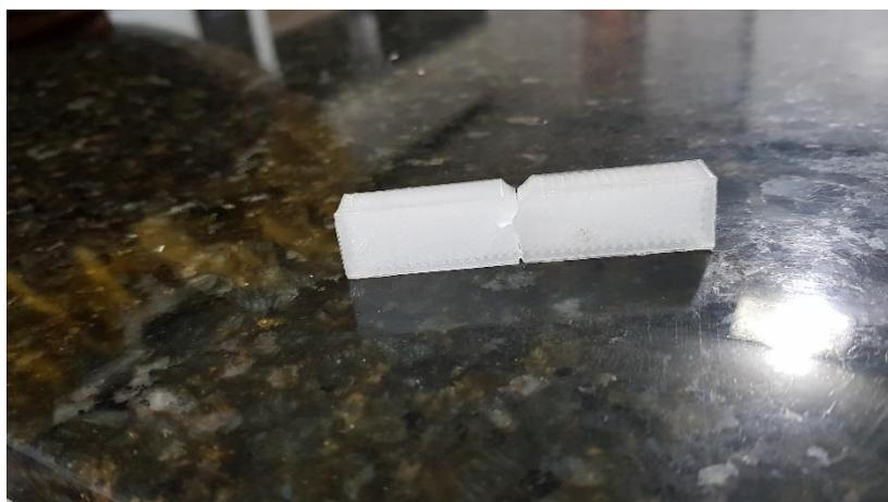
Figura 50: Peça de PETG ensaiada em um pêndulo de impacto Izod (Fonte: Próprio autor, 2018).
