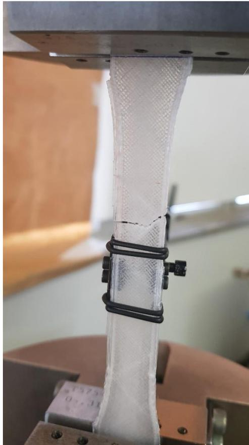
Figura 48: Peça de PLA fraturada em ensaio de tração (Fonte: Próprio autor, 2018).
