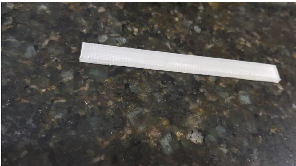
Figura 49: Peça de PETG para ensaio de flexão (Fonte: Próprio autor, 2018).
