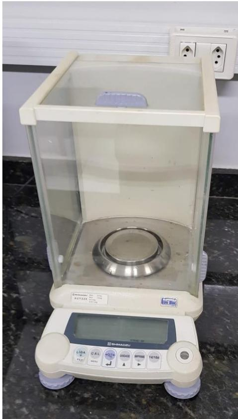
Figura 36: Balança de precisão (Fonte: Próprio Autor, 2018).
