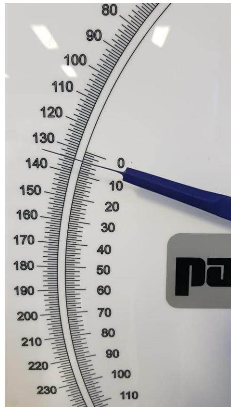
Figura 51: Energia absorvida pela segunda peça de ABS chapado no ensaio de impacto izod
