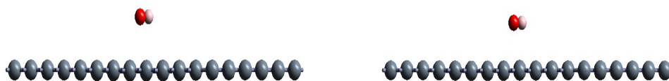
Figura 16. Representação das estruturas otimizadas com o grupo funcional álcool, sendo que na esquerda está a estrutura otimizada com o funcional optPBE-vdW e na direita com o funcional optB86b-vdW.
