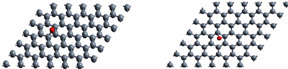
Figura 22. Representação das estruturas otimizadas com o grupo funcional epóxido, sendo que na esquerda está a estrutura otimizada com o funcional PBE e na direita com o funcional D3-BJ para a geometria da configuração 1.
