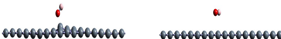
Figura 15. Representação das estruturas otimizadas com o grupo funcional álcool, sendo que na esquerda está a estrutura otimizada com o funcional PBE e na direita com o funcional D3-BJ.
