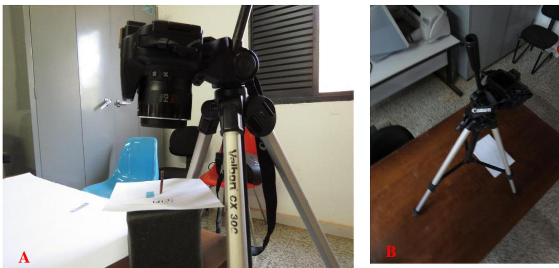
**Figura 2.** Estrutura montada sobre uma superfície plana (tripé e câmera digital) para coleta das fotografias digitais das variáveis de crescimento de mudas clonais de *Eucalyptus*.
