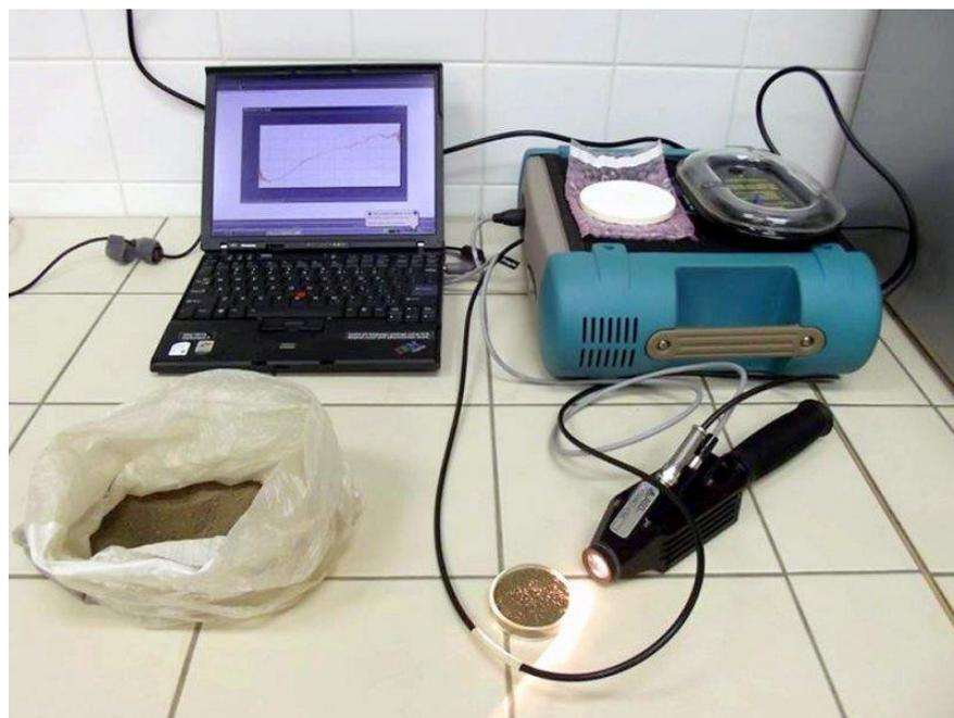
*Figura 5 - Sensor FieldSpec utilizado para obtenção das curvas espectrais.*
