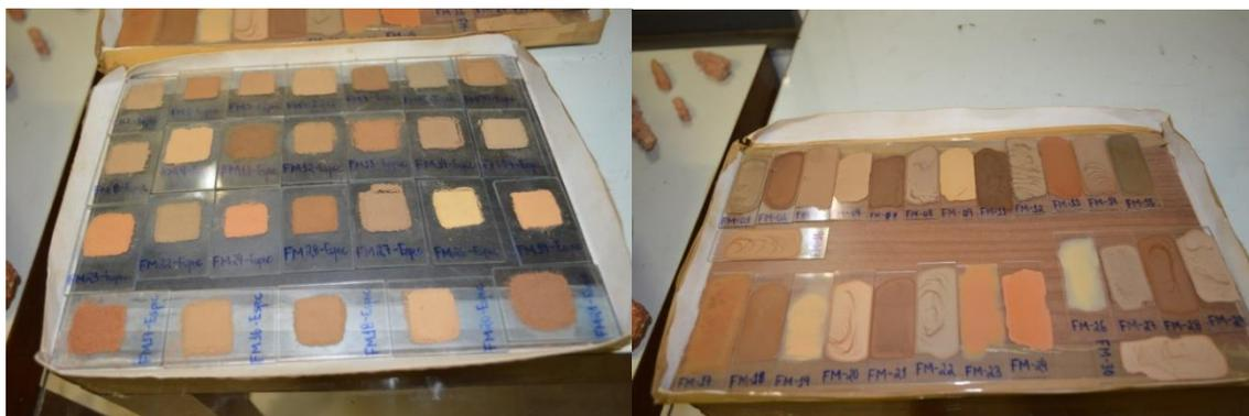
**Figura 7 - Lâminas para análise da fração total e fração argila.**
