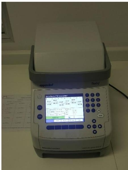
Figura 11 - Termociclador Mastercycler® pro - Cyclers, Eppendorf em funcionamento. Capacidade para placas PCR, tubos PCR 0,2 ml, tubos PCR 0,5 ml e tubos PCR 1,5 ml. (LADTV, 2018) – Arquivo pessoal.
