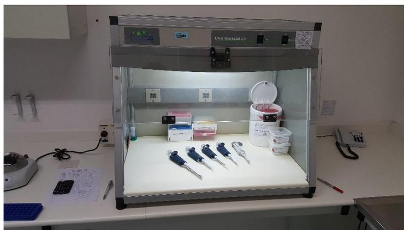
Figura 10 - Cabine asséptica para PCR – DNA Workstation, LOCCUS® (LADTV, 2018) – Arquivo pessoal.
