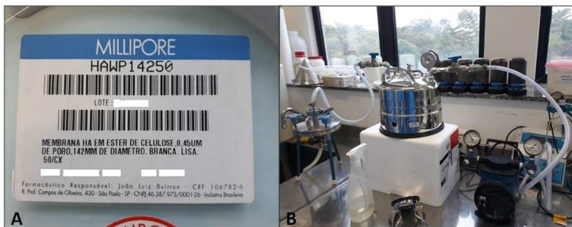
Figura 12. Membrana em Ester de celulose Milipore® (A). Equipamento de concentração de água (B). Fonte: FIOCRUZ, Rio de Janeiro, 2018.
