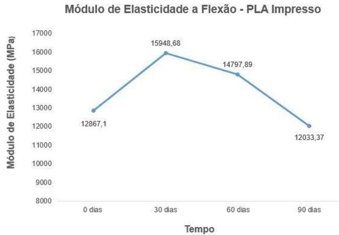
Figura 36. Módulo de Elasticidade a Flexão ao longo dos 90 dias (Próprio Autor, 2019)
