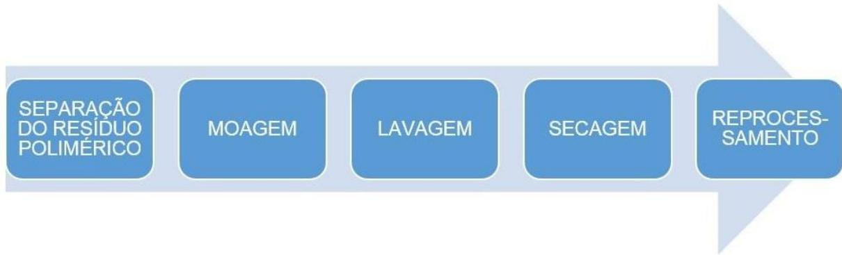
Figura 17. Etapas do processo de reciclagem mecânica (SPINACÉ; PAOLI, 2005. Adaptada)
