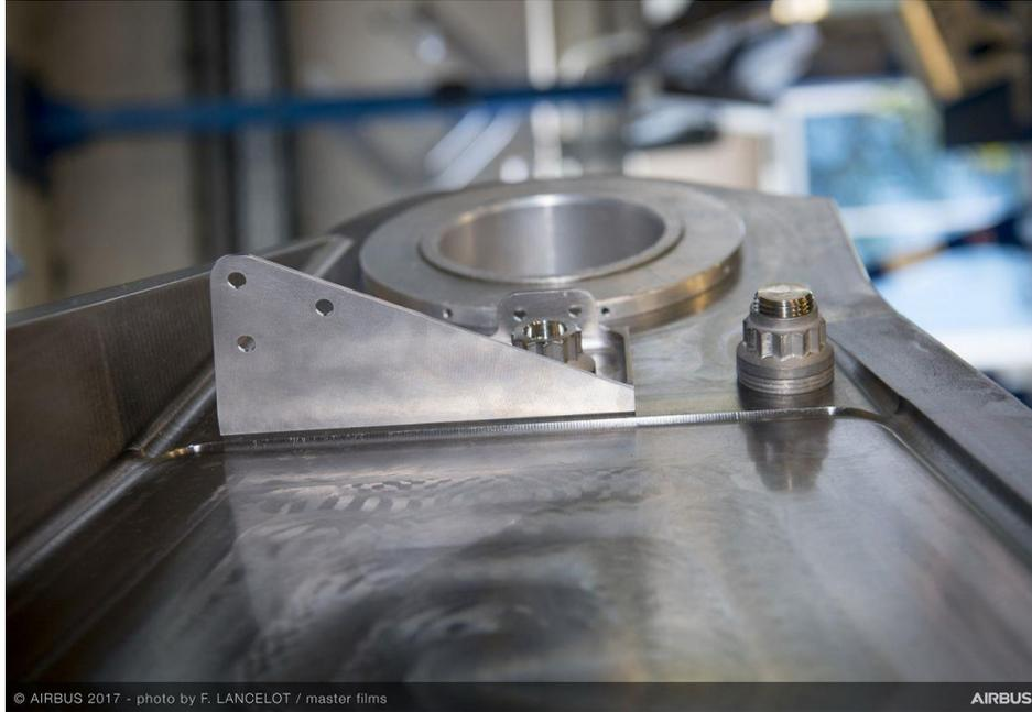
Figura 7. Suporte impresso em 3D instalado no pylon do A350 XWB (AIRBUS, 2017).
