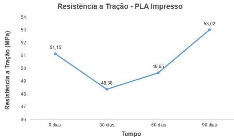
Figura 37. Resistência a Tração ao longo dos 90 dias (Próprio Autor, 2019)
