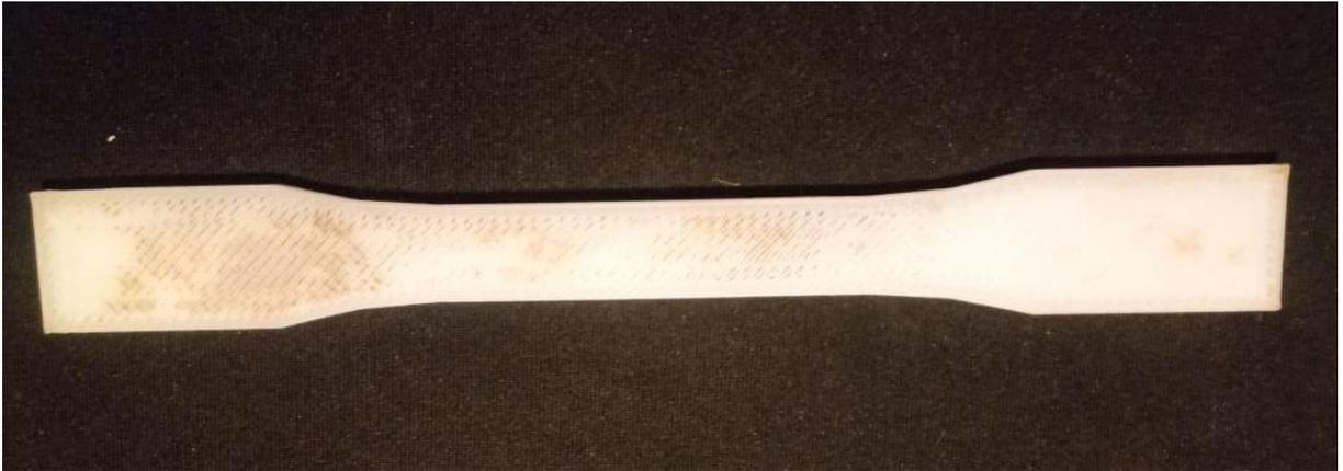
Figura 31. Corpo de Prova de Tração de PLA com 90 dias em solo simulado (Próprio Autor, 2019)
