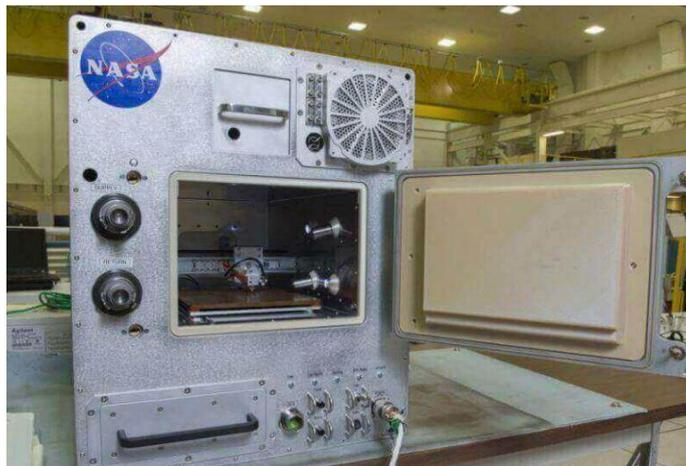
Figura 13. Refabricator da NASA passando por testes no Marshall Space Flight Center (ALL3DP, 2017)
