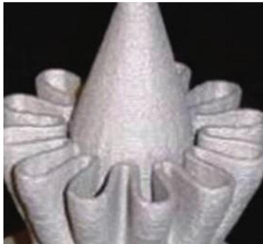
Figura 8. Duto Exaustor fabricado usando o processo LDM/LENS (LIU, 2016).
