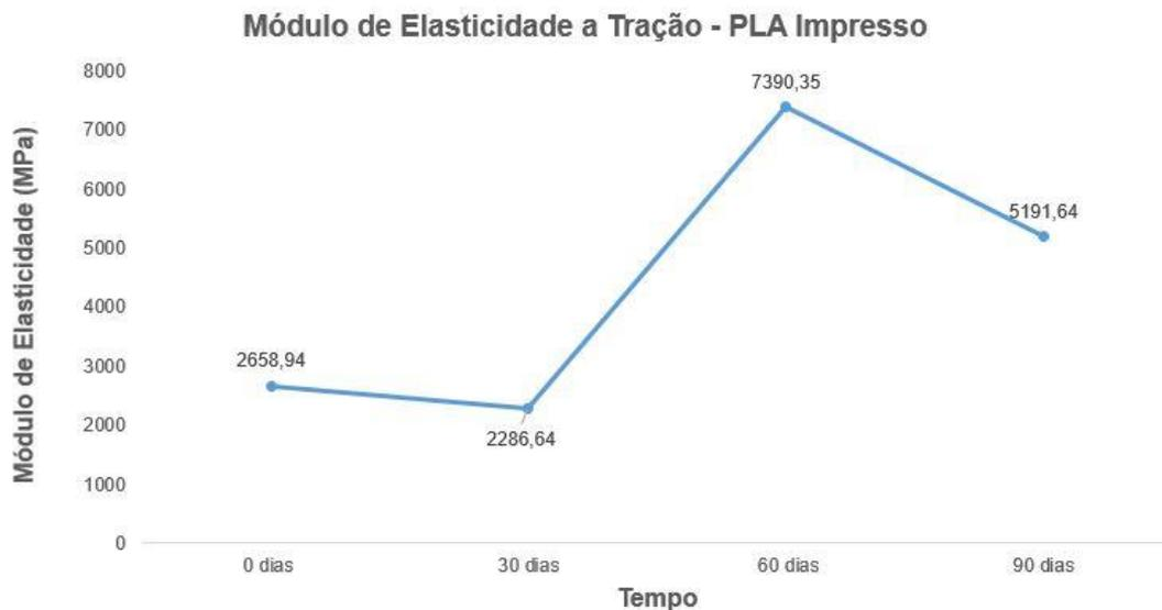
Figura 38. Módulo de Elasticidade a Tração ao longo dos 90 dias (Próprio Autor, 2019)
