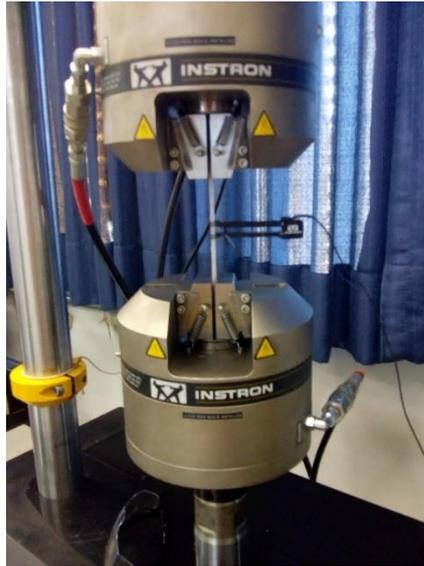
Figura 29. Máquina de Ensaio Universal INSTRON 8801 (Próprio Autor, 2018)
