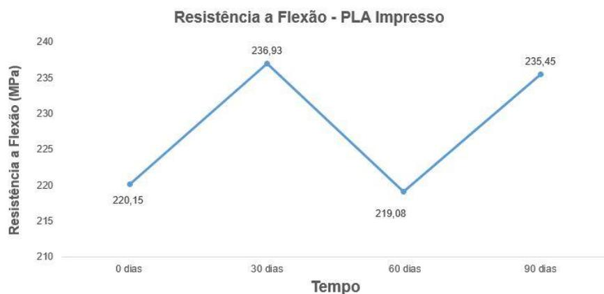
Figura 35. Resistência a Flexão ao longo dos 90 dias (Próprio Autor, 2019)
