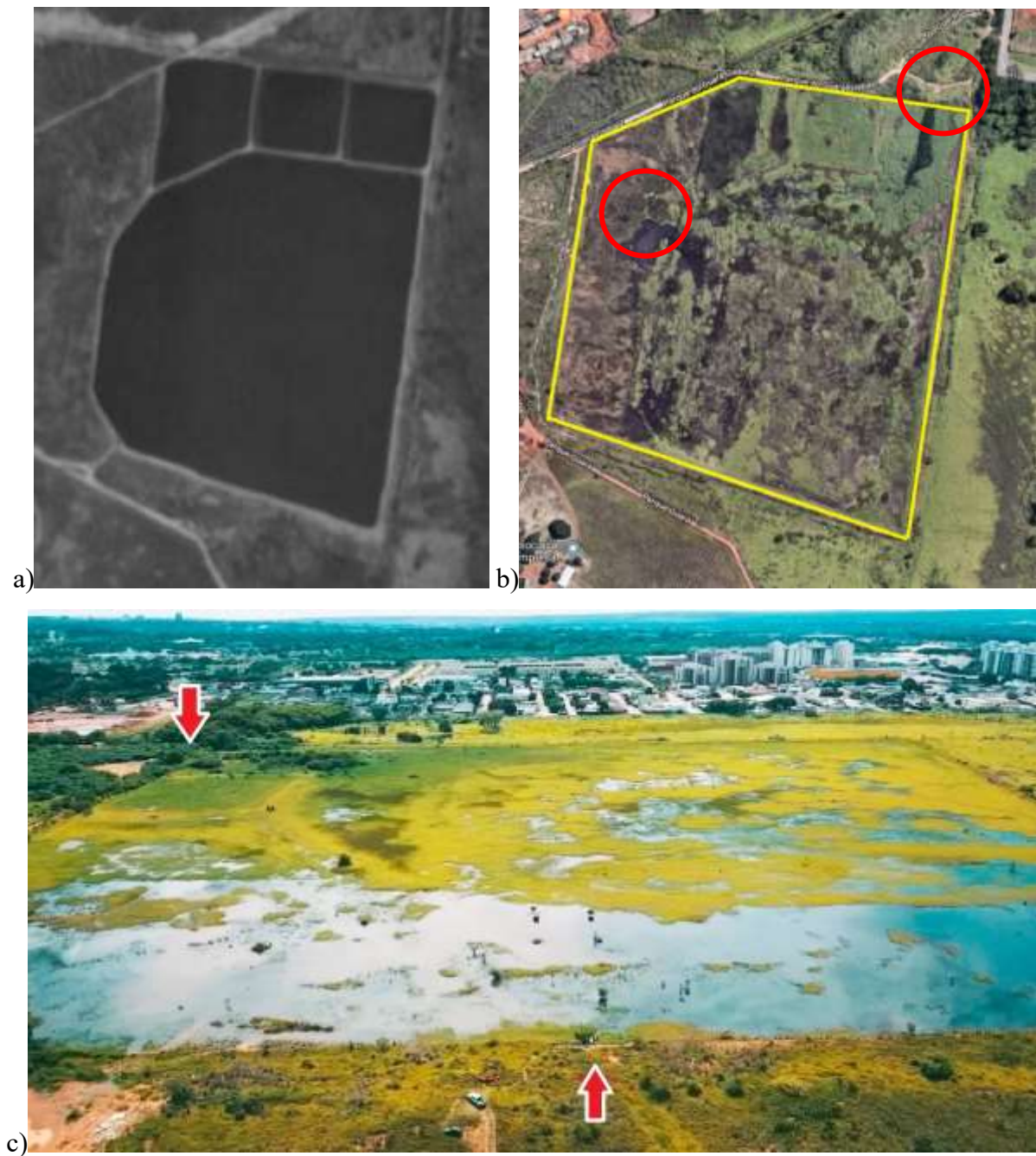
Figura 4.7 – Área da bacia de detenção, sendo: a) antiga lagoa de estabilização da CAESB em 1991; b) atual bacia de detenção em 2018; c) vista superior.
