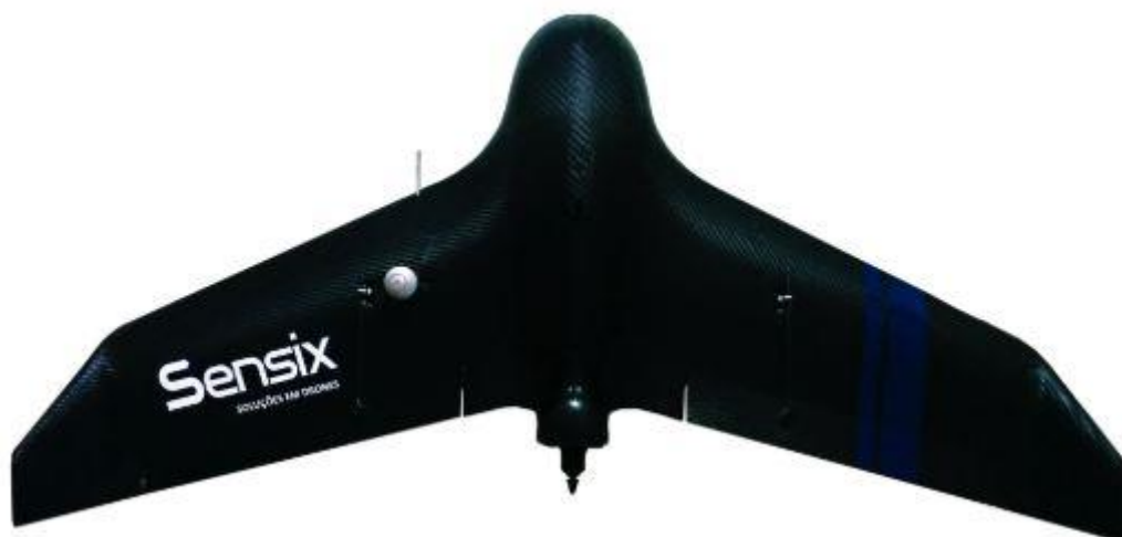
Figura 3.4 – VANT de asa fixa. Modelo M3 de alto desempenho para mapeamento aéreo da Sensix Fonte: Sensix (2016)
