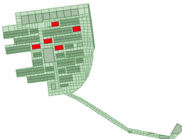
Figura 5.17: Aplicação de trincheiras de infiltração na Bacia 2.
