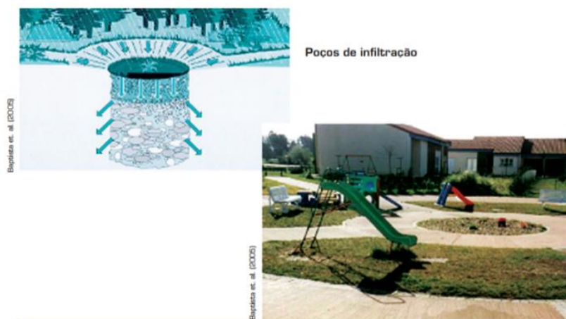
Figura 3.9: Exemplo de poços de infiltração.
