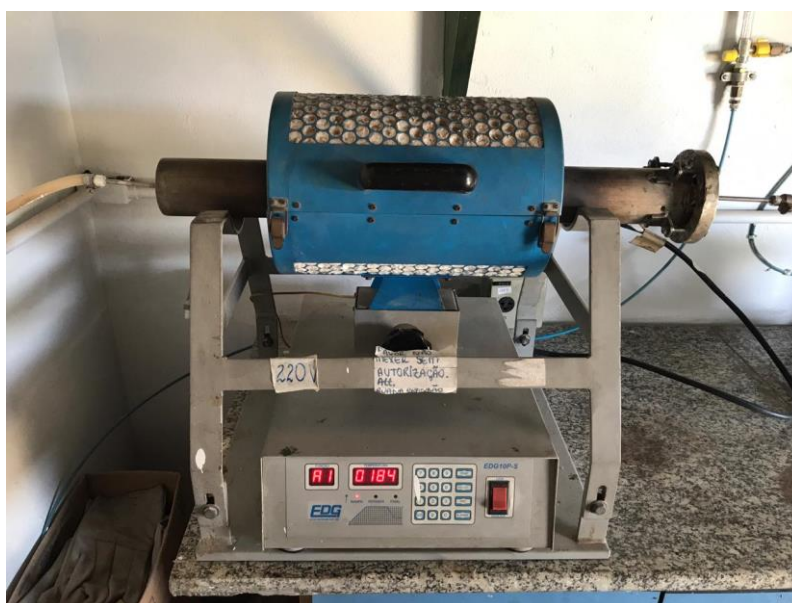
Figura 4.4 Forno utilizado na etapa de carbonização
