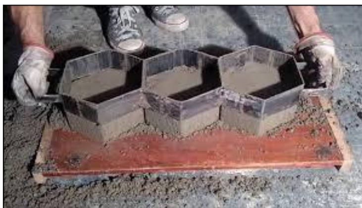
Figura 6.45 – Fabricação de bloquetes para calçadas (Crédito: Pideju Metal)
