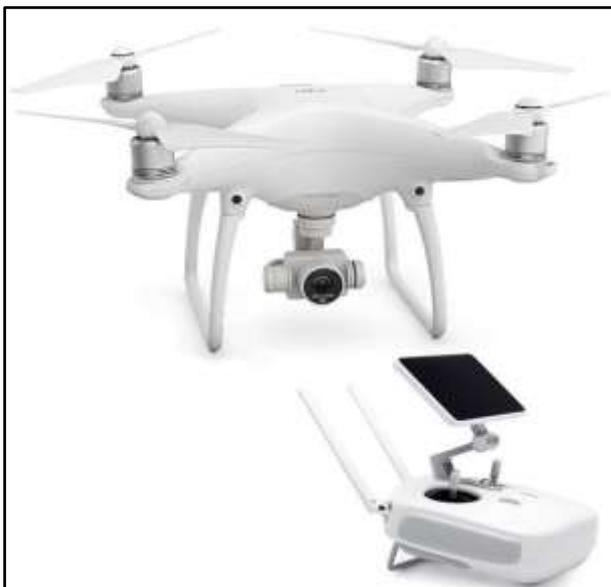
Figura 2: Aeronave Pilotada Remotamente (RPA) tipo Phantom IV usada na aquisição de imagens nesta pesquisa. Fonte: <https://www.dji.com/>
