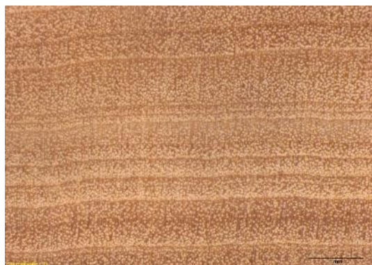
Seção transversal macroscópica no aumento de 20x.
