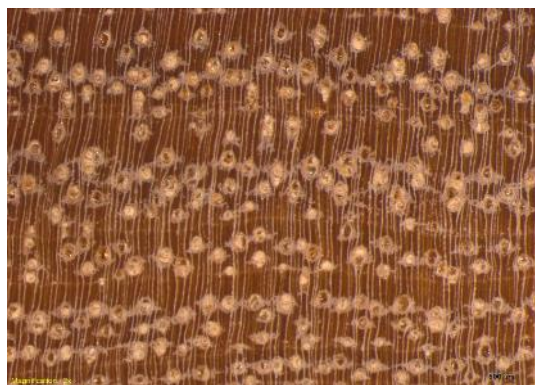
Seção transversal macroscópica no aumento de 20x.
