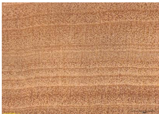
Seção transversal macroscópica no aumento de 20x.
