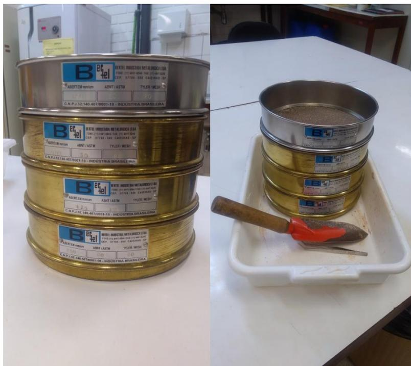
Figura 4: As quatro peneiras utilizadas (esquerda); pá, pinça e peneiras utilizadas na obtenção de sementes (direita). Fonte: Gonçalves, 2018.
