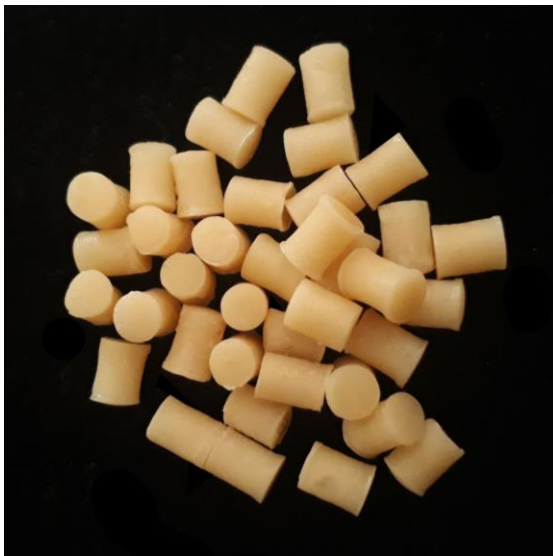
Figura 3 – Amostras de resina acrílica autopolimerizável (Dencrilay Speed, VIPI, Brasil), após serem retiradas da matriz metálica
