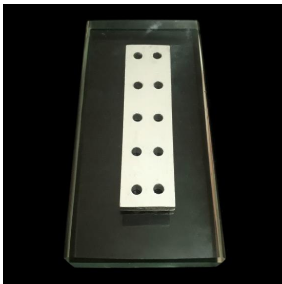
Figura 2 – Matriz metálica e placa de vidro, utilizadas durante a confecção das amostras
