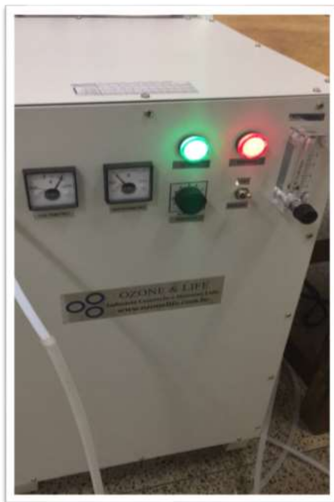
Figura 1 – Equipamento gerador de ozônio e exposição das sementes à água ozonizada, UNB, Brasília, DF, 2017.
