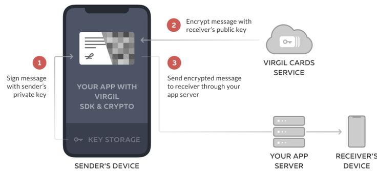
Figura 10 – Esquema completo de encriptação.
