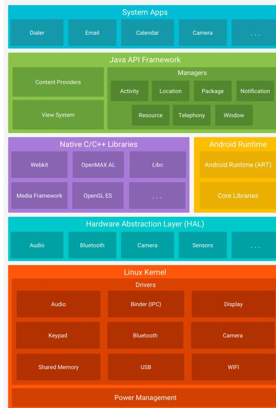
Figura 49 – Componentes da arquitetura do Android.
