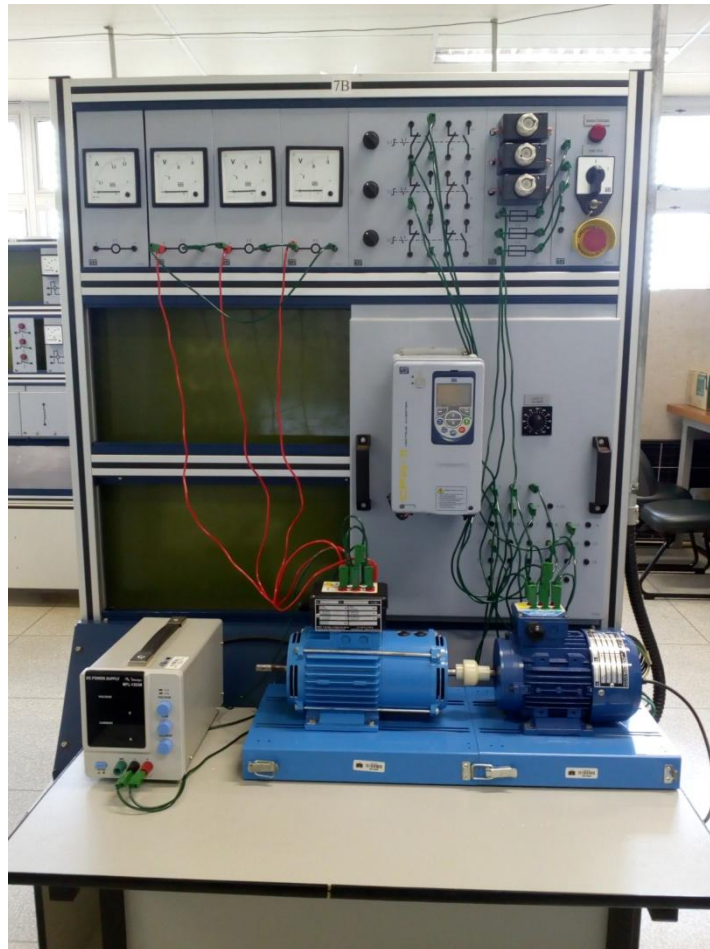
Figura 13. Prática com gerador síncrono a vazio.
