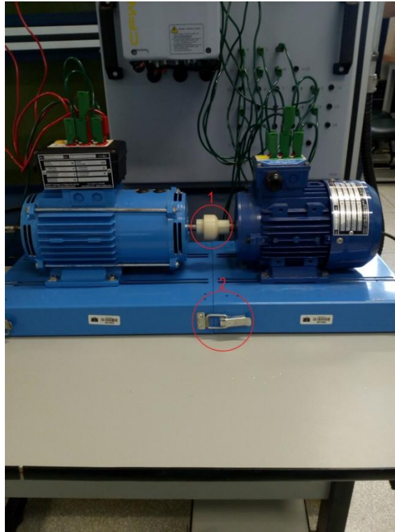
Figura A.1. Acoplamento entre motor assíncrono e gerador síncrono.
