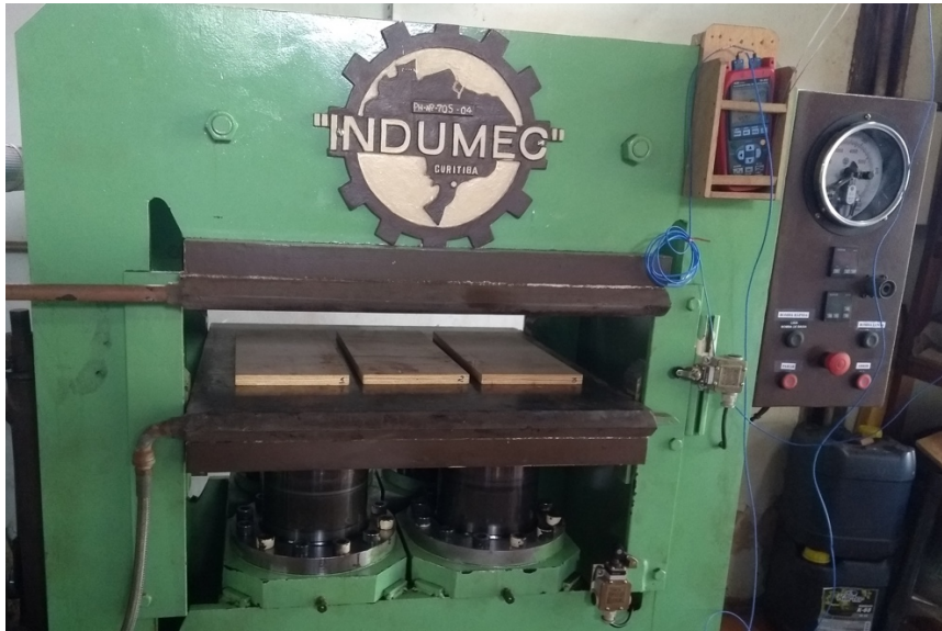
Figura 6: Painéis na prensa hidráulica INDUMEC e TermoPar com fios em contato com a prensa e na linha de cola central.
