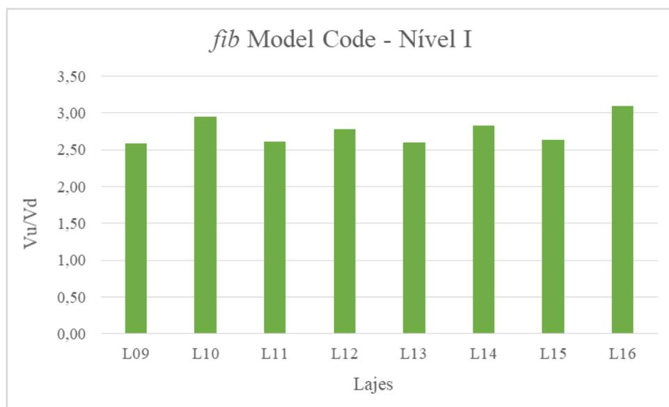
Gráfico 4.11 - Relação entre força de ruptura e estimada pelo nível I de aproximação do *fib* Model Code 2010.
