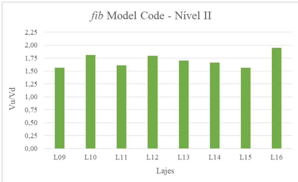
Gráfico 4.12 - Relação entre força de ruptura e estimada pelo nível II de aproximação do *fib* Model Code 2010.
